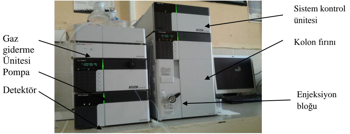
Resim 2.1. Deneylerde kullanılan YPSK cihazı ve genel görünümü
