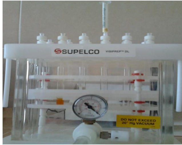
Resim 4.1. Katı faz özütleme düzeneđi
