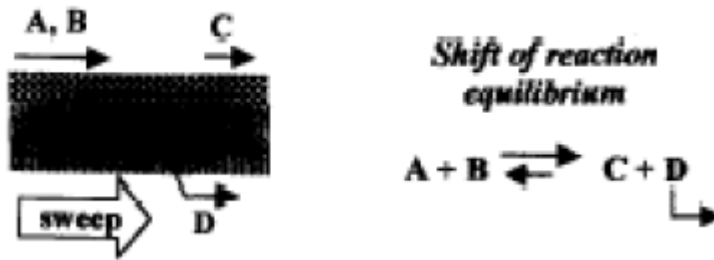
Resim 2.16. Extractor konfigürasyonunun şematik olarak gösterimi. -distributor: Reaktanların kontrol edilerek eklenmesi yan reaksiyonları azaltmaktadır.
