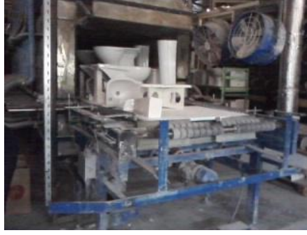
Resim 3.9. Pişme deformasyonu için kullanılan rulo fırın
