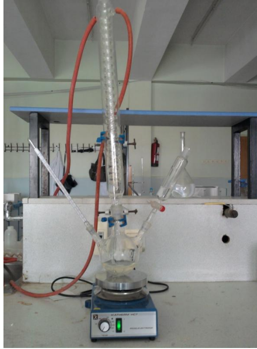
Resim 3.1. MA-AA kopolimerinin sentezlendiği deney düzeneği
