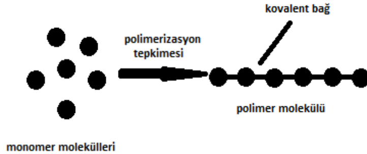
Şekil 2.7. Monomer moleküllerinin polimerleşmesi (Saçak, 2002)
