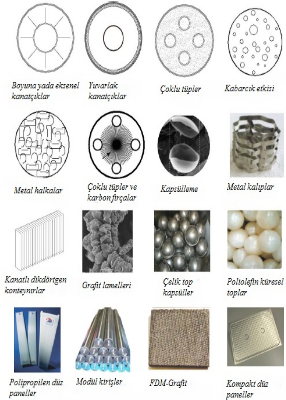
Şekil 1.4. Faz deęiřtiren malzemelerde ısııl performansını iyileřtirme yöntemleri
