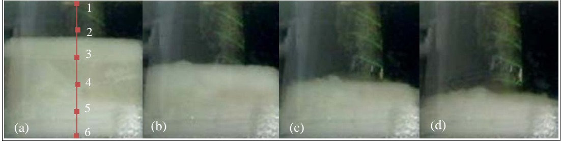
Resim 4.7. Üstten ısıtma konumunda FDM’nin erime oranları ( \dot{q}=4460 \text{ W/m}^2 ) (a) 300dk (b) 600dk (c) 900dk (d) 1200dk
