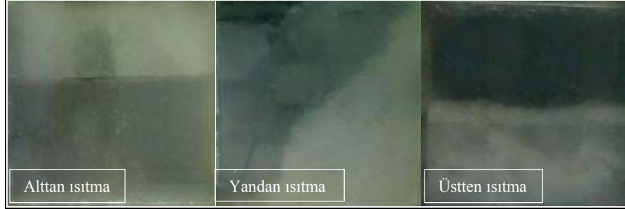
Resim 4.19. Isıtma konumunun etkisi ( \dot{q}=1310 \text{ W/m}^2 , 480dk)
