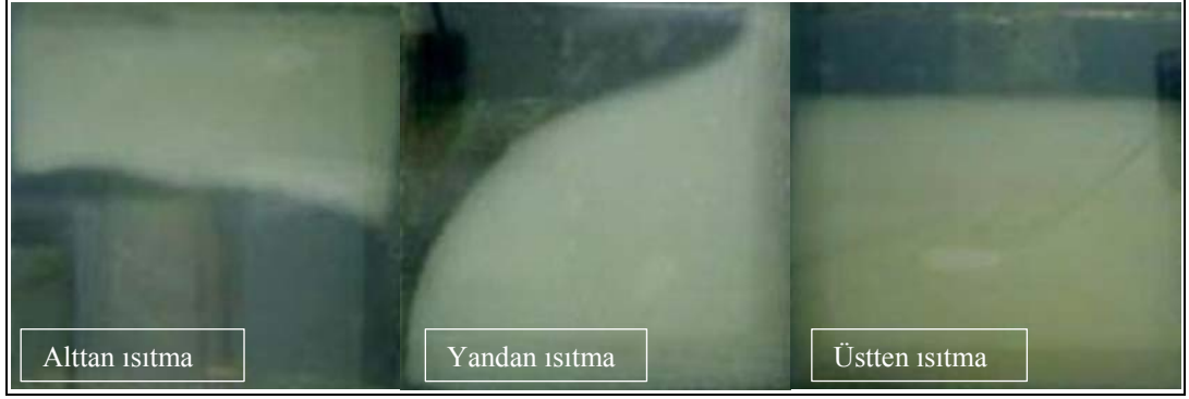
Resim 4.4. Isıtma konumunun etkisi ( \dot{q}=3000 \text{ W/m}^2 , 600dk)
