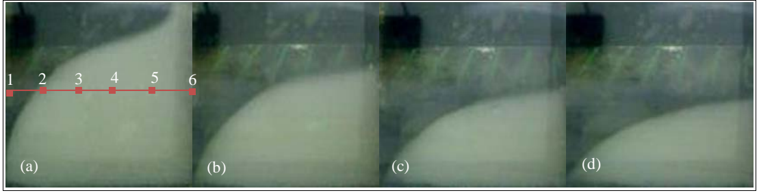
Resim 4.2. Yandan ısıtma konumunda FDM’nin erime oranları ( \dot{q}=3000 \text{ W/m}^2 ) (a) 600dk (b) 1200dk (c) 1800dk (d) 2400dk
