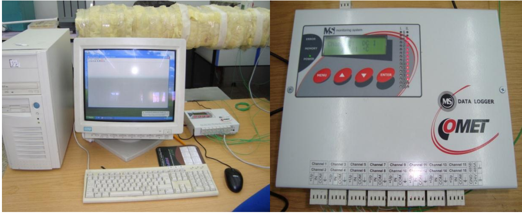
Resim 3.2. Veri kayıt sistemi ve COMET MS6D veri kayıt cihazı
