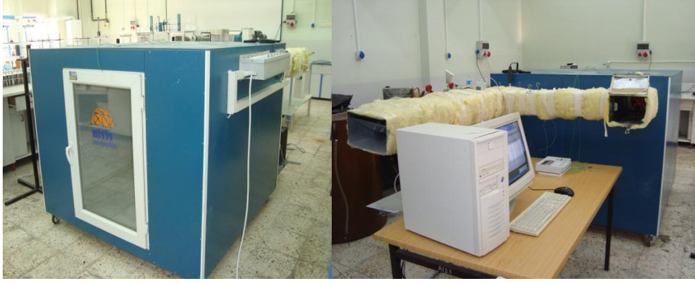
Resim 3.1. İmal edilen iklimlendirme deney odası
