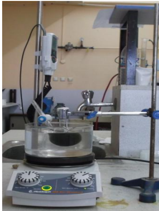
Resim 3.7. Reaksiyon karışımının yağ banyosunda polimerizasyonu
