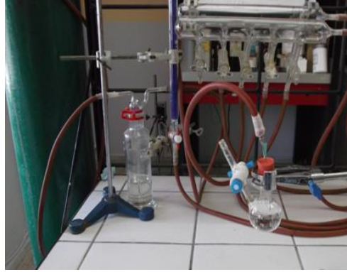
Resim 3.3. Vakum- azot işleminin uygulanması
