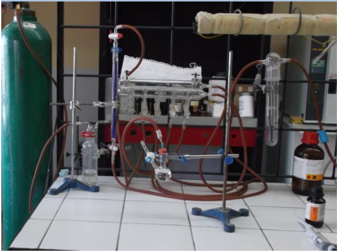
Resim 3.6. P t BA sentezi için vakum-azot işleminin uygulanması
