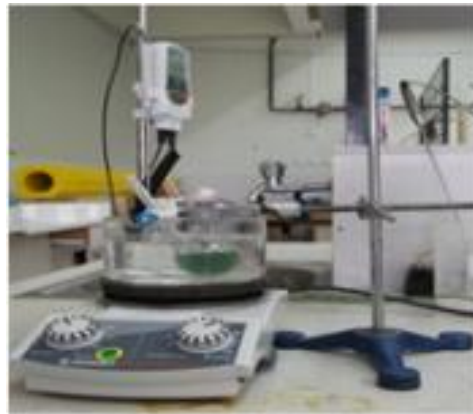
Resim 3.4. Reaksiyon karışımının yağ banyosunda polimerizasyonu
