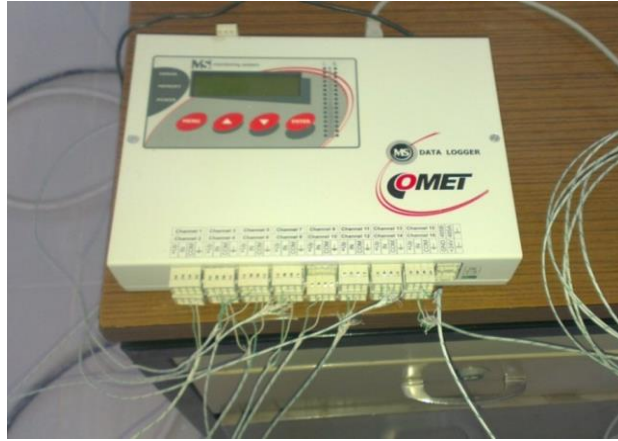
Resim 3.3. COMET MS6D Veri Kayıt Cihazı
