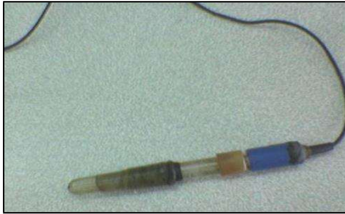
Şekil 3.5. Deneyde kullanılan Doymun Kalomel Elektrot (DKE)
