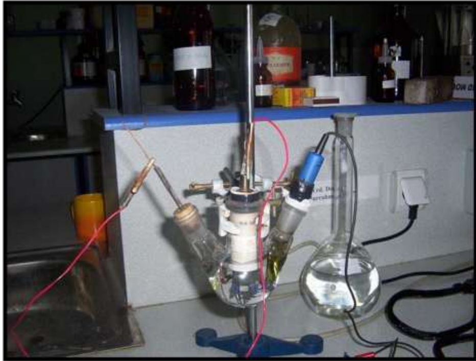
Şekil 3.4. Korozyon hücresinin fotoğrafı
