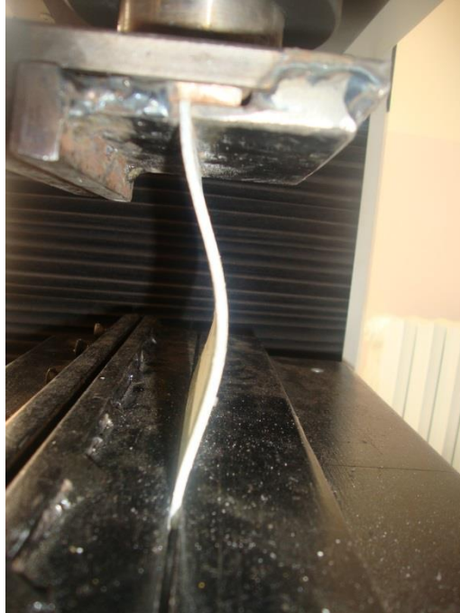
Resim 6.11. Yükleme testi sonunda numunedeki burkulmanın gösterimi
