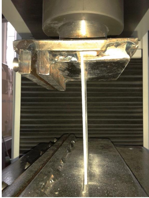
Resim 6.10. Alt ve Üst aparatlar ile levhanın sınır şartlarının sağlanması
