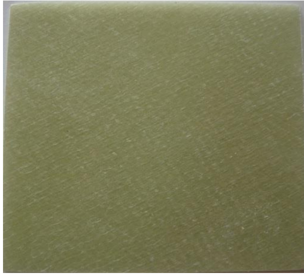
Resim 6.4. Numune [(-30/30)_2]_s , [(-45/45)_2]_s , [(-60/60)_2]_s ve [(0/90)_2]_s oryantasyon açılarında, deliksiz, 100x100 mm kare levha
