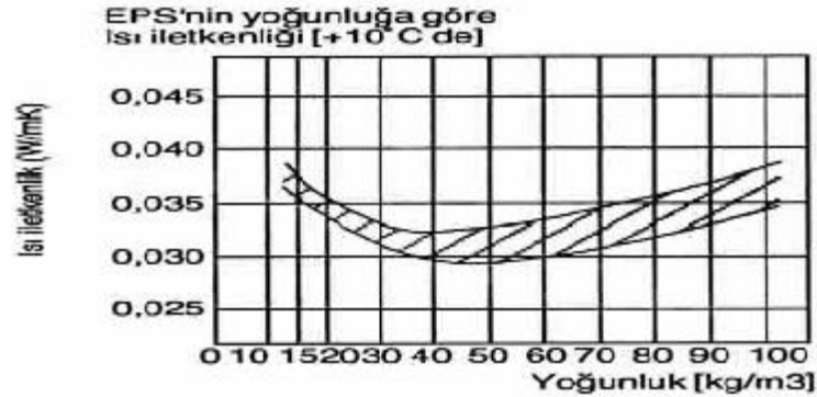
Şekil 3.2. EPS'nin yoğunluğa göre ısı iletkenliği
