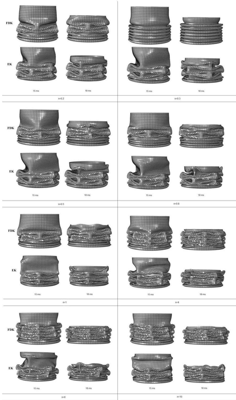
Şekil 5.6. Seçilmiş bazı fonksiyonel olarak derecelendirilmiş ve eşdeğer kalınlıklı tüplerin farklı n değerlerindeki deformasyon şekilleri
