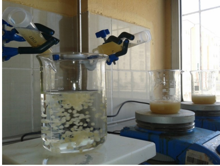
Resim 5.1. Ayçekirdeği kabuğu-kitosan immobilize ürününün hazırlanması
