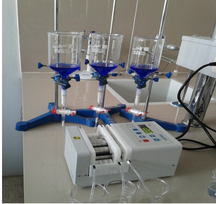
Resim 5.2. Sürekli sistemde biyosorpsiyon çalışmaları
