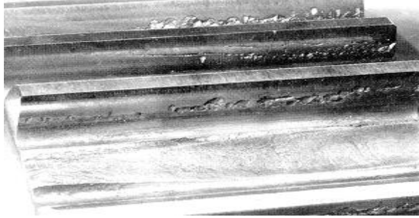
Resim 2.12. Pitting kaynaklı kırılma
