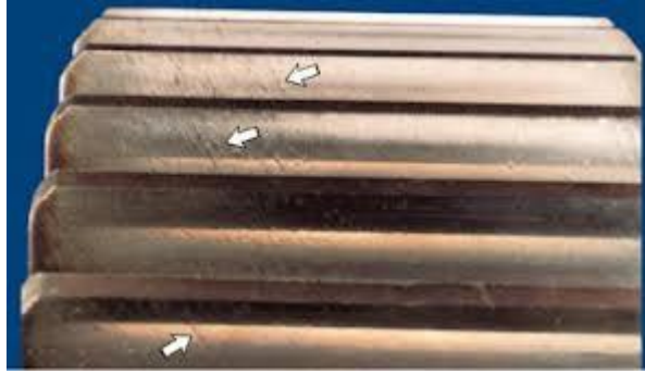
Resim 2.7. Yüzeyi sertleştirilmiş dişlide adhesiv aşınma
