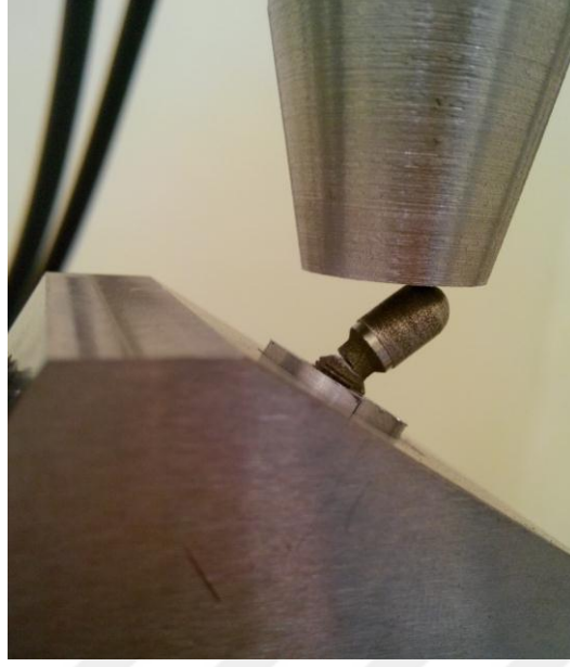
Şekil 6.16. DMLS ile üretilmiş numunelerde yorulma testi sonrası örnek kırılma şekli
