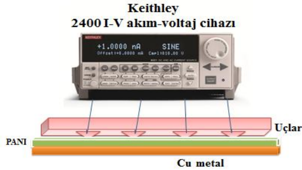
Resim 4.1. Metal üzerine anilin buharı ve anilin-Cl nin BFP ile elde edilen örneklerin iletkenlikleri ölçümlerinin yapılması
