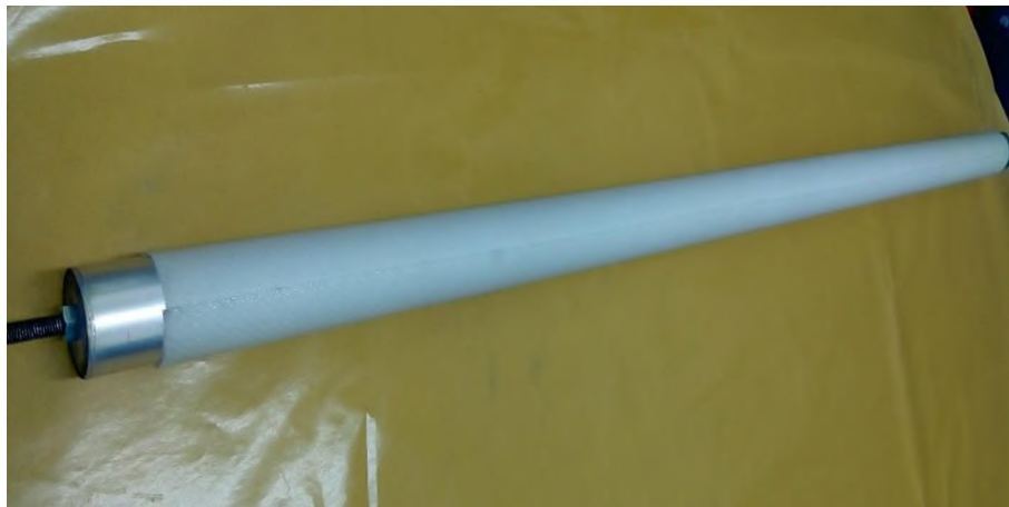
Resim 4.3. Prepreg malzemenin kalıba sarılmış hali
