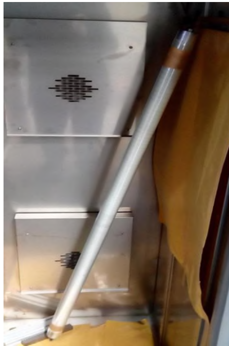
Resim 4.5. Kompozit borunun fırınlanma görüntüsü
