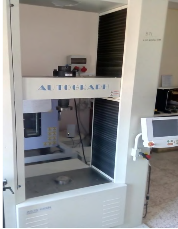
Resim 3.1. Statik basma deneyi cihazı
