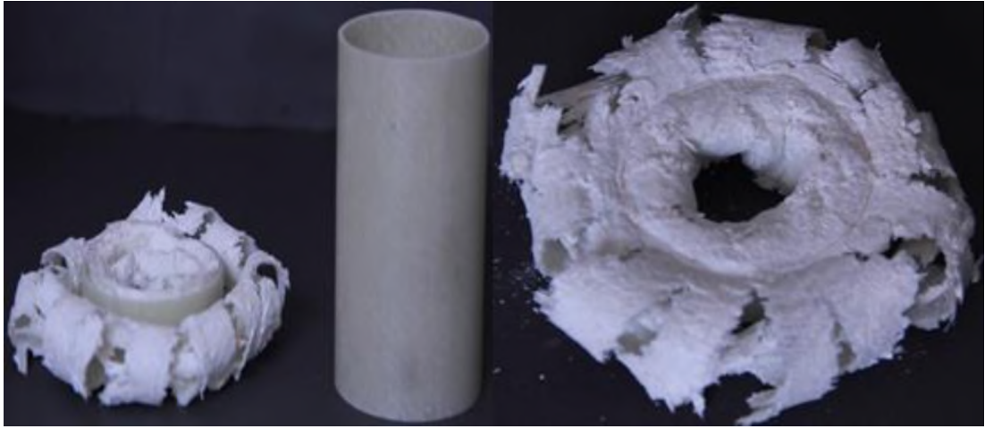
Resim 5.4. Boyu 100 mm. çapı 60 mm. olan numunenin hasarsız ve hasarlı görüntüleri
