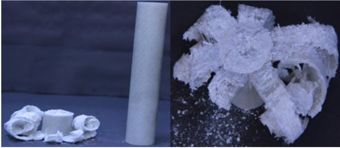
Resim 5.5. Boyu 150 mm. çapı 20 mm. olan numunenin hasarsız ve hasarlı görüntüleri
