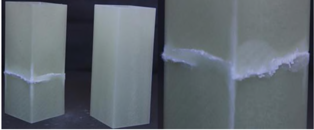
Resim 5.9. Boyu 100 mm. kenar uzunluğu 40 mm. olan numunenin hasarsız ve hasarlı görüntüleri
