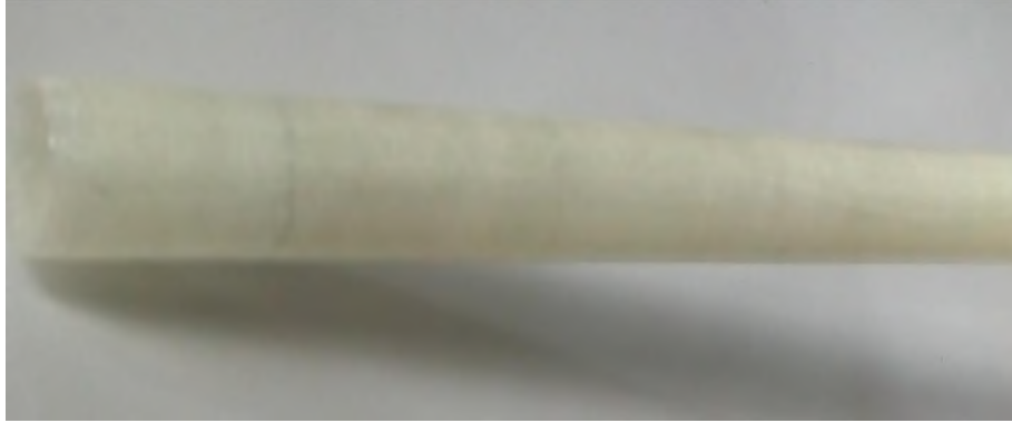
Resim 4.6. Kalıptan ıkarılan cam elyaf kompozit boru
