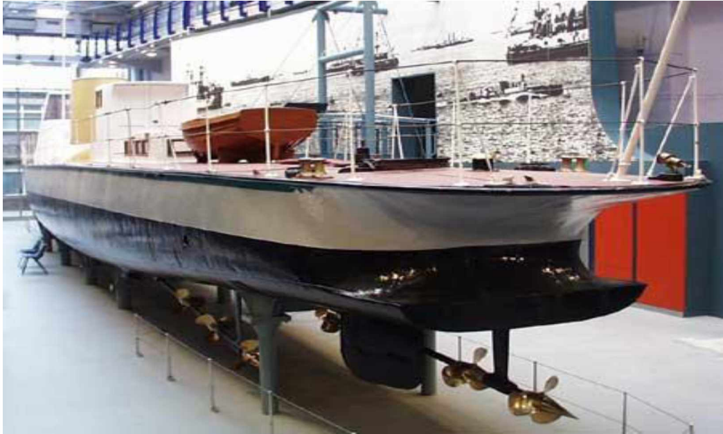
Resim 2.5. Tandem pervane sistemine sahip bir gemi
