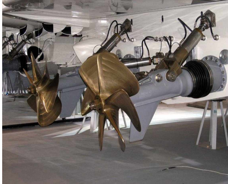
Resim 2.8. SG botunda kullanılan yüzey yarıcı pervane
