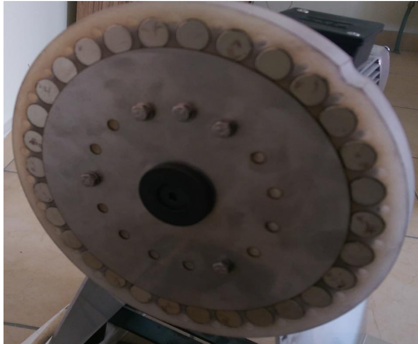
Resim 4.6. Döner tabla mıknatıs yerleşimi ve koruma sacı eklenmesi
