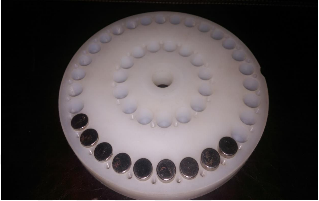
Resim 4.5. Polyamid disk mıknatıs yerleşimi
