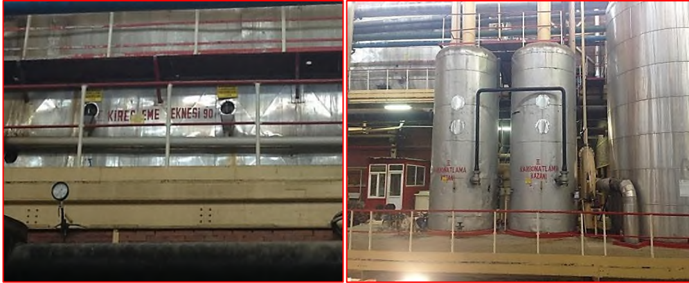
Resim 2.3. Kireçleme ve karbonatlama işlemleri
