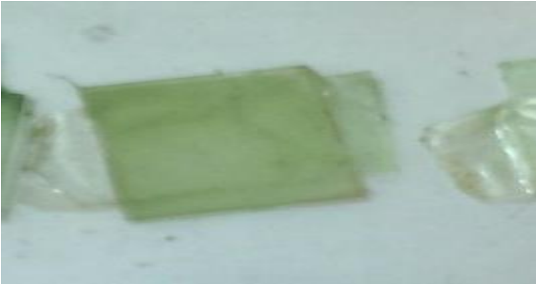
Resim 5.5. Polivinil klorür+Anilin karışımı ile kaplanıp BFP ile polimerleştirilmiş film örneği
