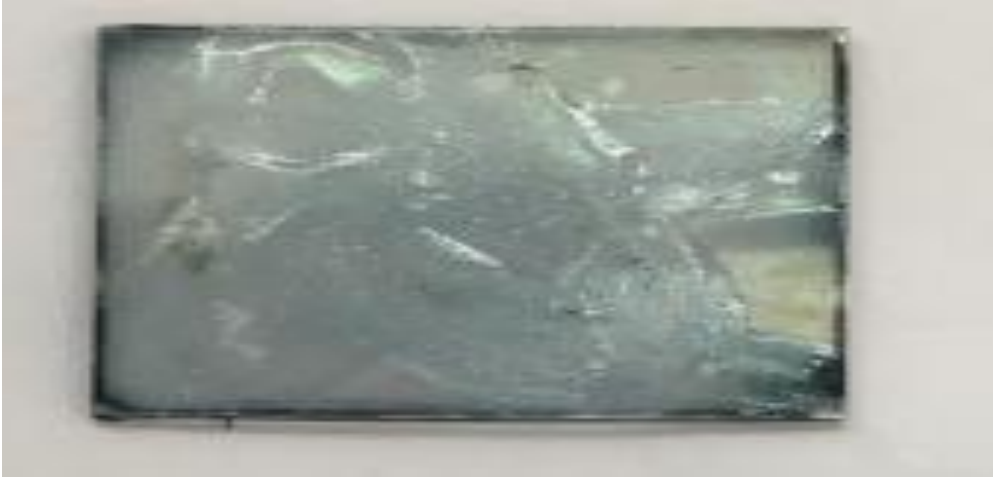
Resim 5.2. Kloro-sülfolanmış-polietilen+anilin karışımı ile kaplanıp buhar fazı polimerizasyonu ile polimerleştirilmiş film örneği
