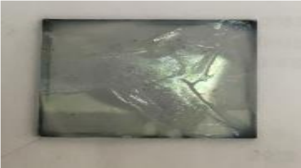
Resim 5.3. Vinil klorür-akrilonitril kopolimeri +Anilin karışımı ile kaplanıp buhar fazı polimerizasyonu ile polimerleştirilmiş ITO örneği
