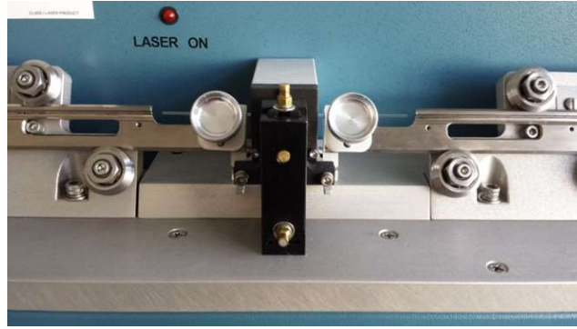
Resim 4.1. Lazer-esaslı cihaza ortalanarak yerleştirilmiş borosilikat cam
