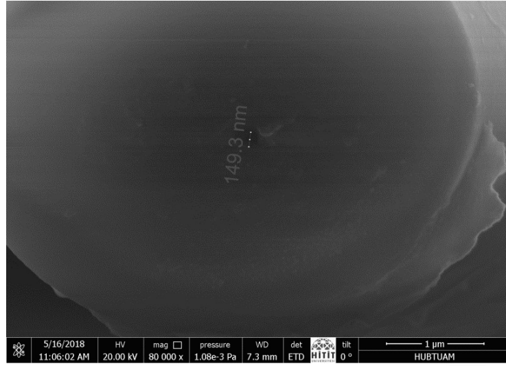
Resim 4.16. Nano (2) elektrodun uçtaki platinin SEM görüntüsü (149,3 nm)
