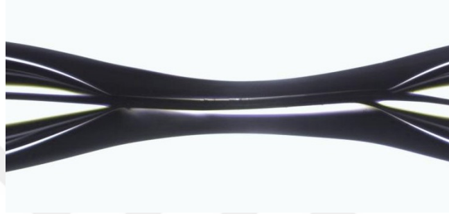
Resim 4.4. Mikroelektrot üretim aşamasında kaynaştırma işlemi (Mikroskop görüntüsü). Heat; 400, Filament; 4, Velocity; 15, Delay; 120, Pull; 0 parametreleri kullanılmıştır. 4 s lazer verip 1 dakika bekledikten sonra tekrar 10 s lazer ışını uygulanmıştır
