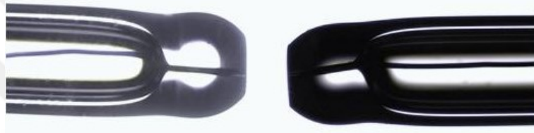
Resim 4.6. Mikroelektrot üretim aşamasında parlatma işlemi (Mikroskop görüntüsü). P600, P800, P1200, P2500 zımpara kağıtları ile yapılmıştır
