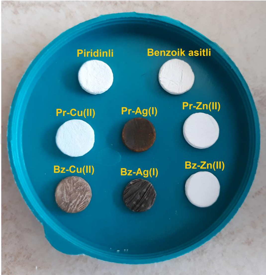
Şekil 3.4. Metal bağlanmış p -amino benzoik asit ve p -amino piridinli kriyojeller
