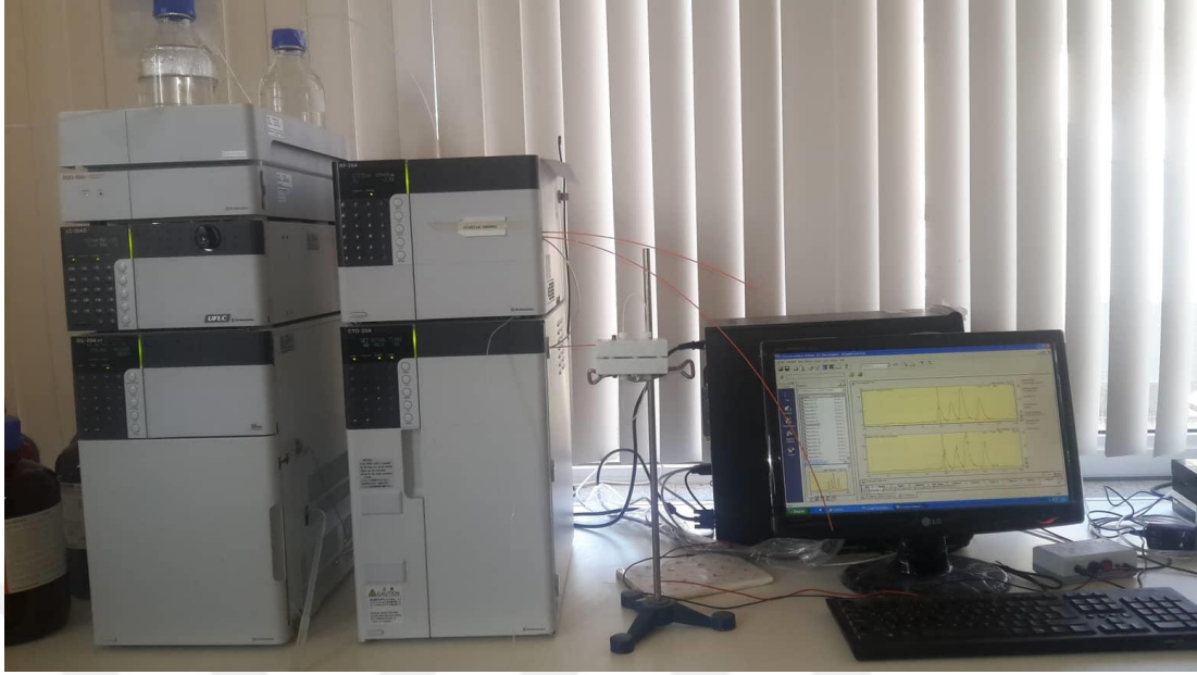
Resim 3.2. AFs'in analizlerinde kullanılan HPLC cihazı
