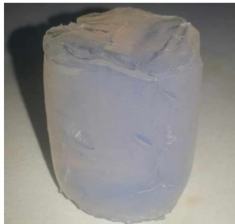
Resim 3.3. Metanol banyo süresi tamamlanan alümina alkojel
