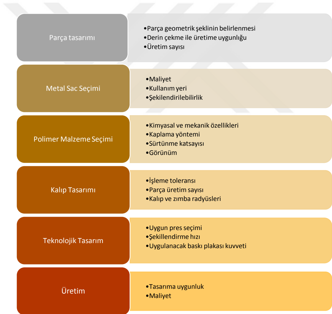
Őekil 3.1. Polimer kaplamalı metal sacların derin ekme sreci
