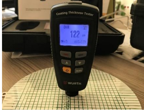
Resim 3.18. Derin çekme öncesi numunelerin kaplama kalınlıklarının ölçümü
