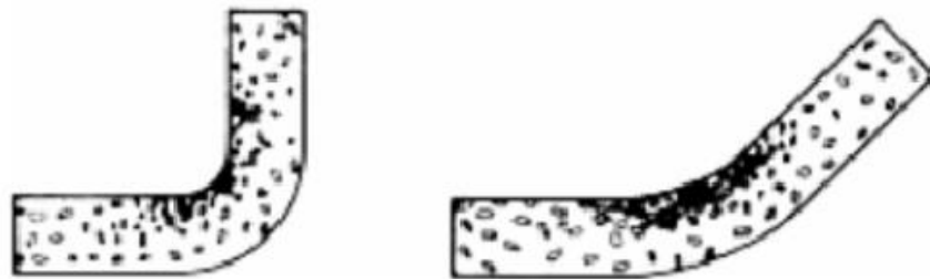
Şekil 2.10. Bükme işleminin sebep olduğu atom hareketleri (Özdemir, 2015)
