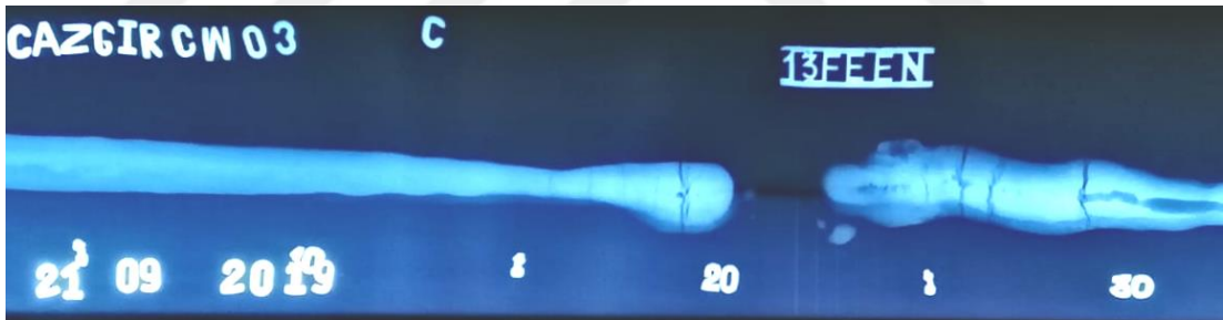
Resim 3.26. C kodlu kaynak X-ışını radyografik filmi
