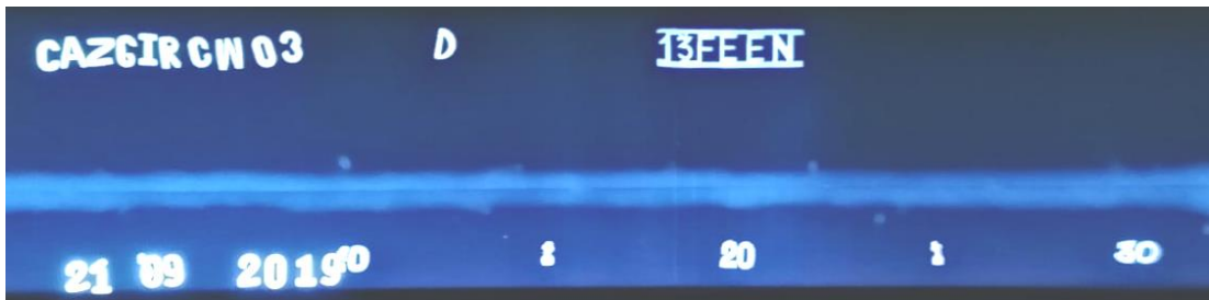
Resim 3.27. D kodlu kaynak X-ışını radyografik filmi
