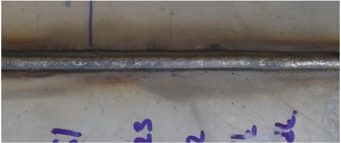
Resim E1.6. 1 numaralı kaynak kep bölgesi görünüm
