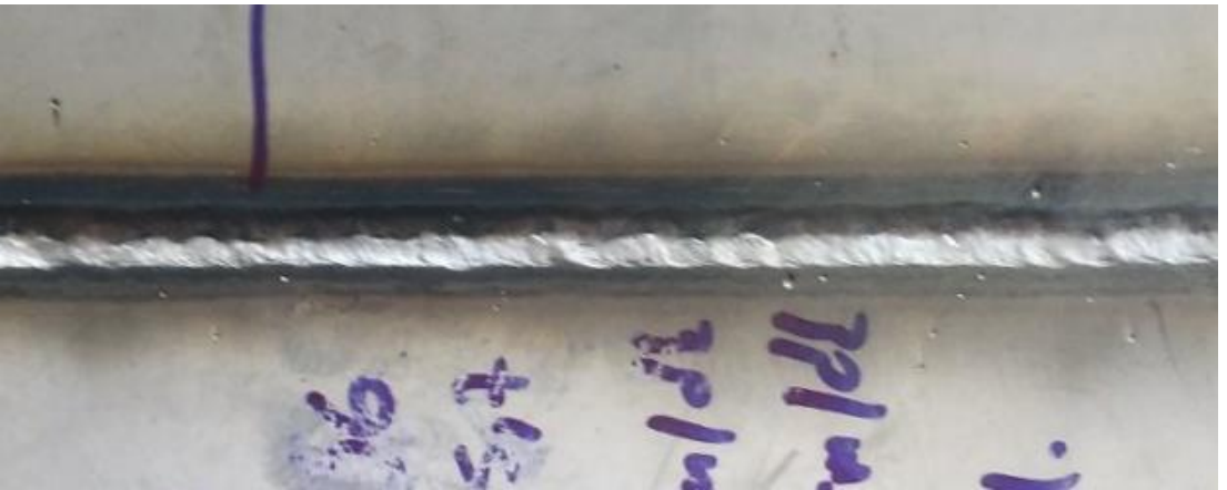
Resim E1.9. 5 numaralı kaynak kep bölgesi görünüm
