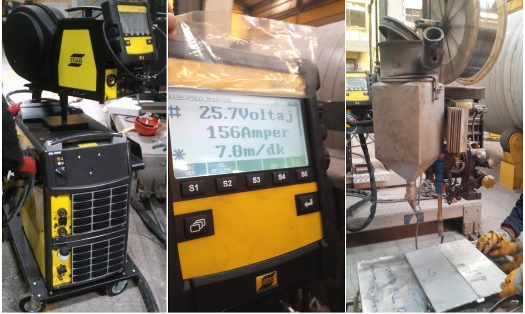
Resim 3.1. Kullanılan kaynak makinesi ve hareketli mekanizma
