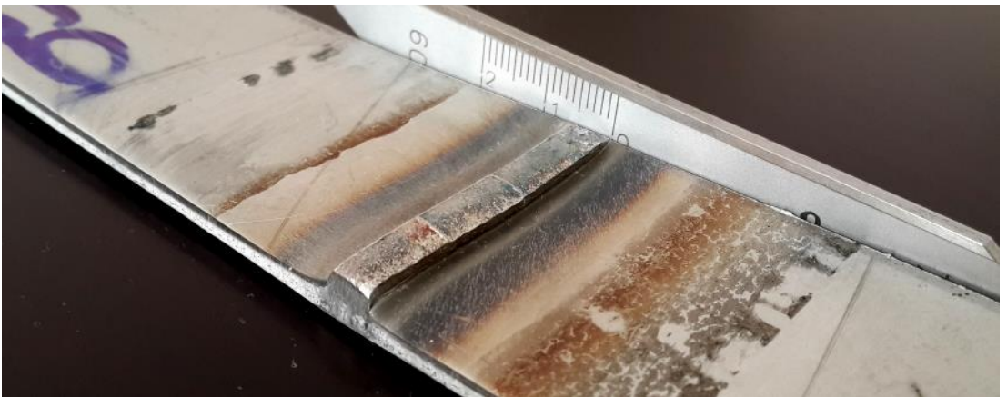
Resim E1.15. 2 numaralı kaynak kök bölgesi görünüm
