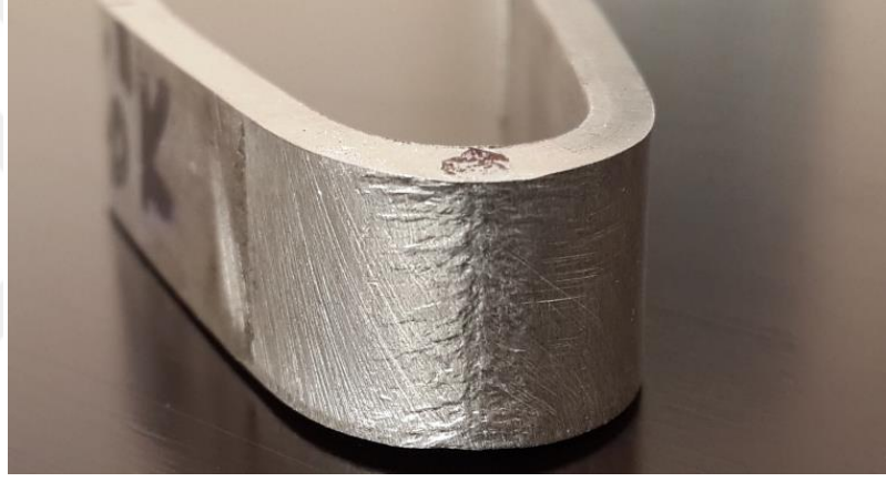
Resim E1.20. 1 numaralı kaynak kök kısmı eğme görüntüsü
