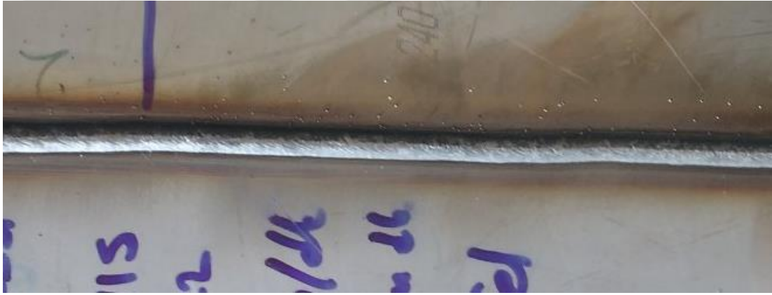
Resim 3.17. 3 numaralı kaynak kep bölgesi görünüm
