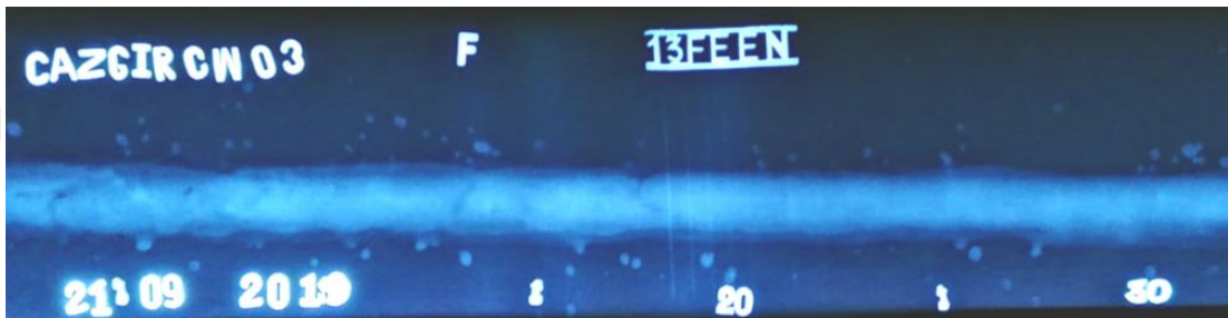
Resim 3.29. F kodlu kaynak X-ışını radyografik filmi
