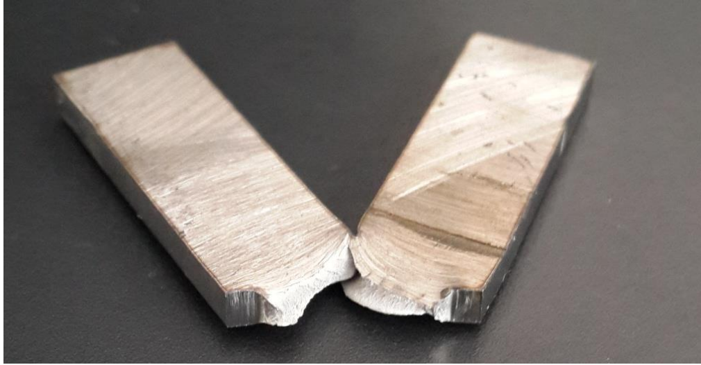
Resim 3.38. Numunenin darbeden sonra kaynaktan kırılma görüntüsü
