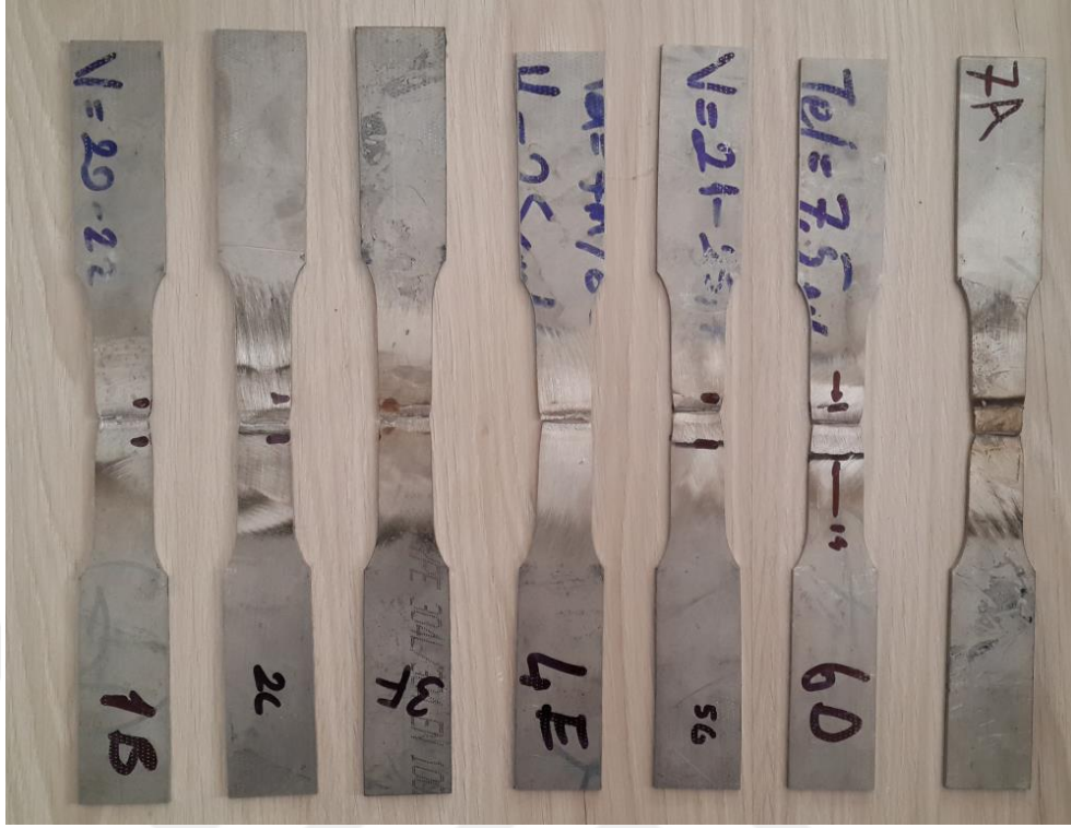
Resim 3.35. Numunelerin çekme deneyinden sonraki görüntüsü
