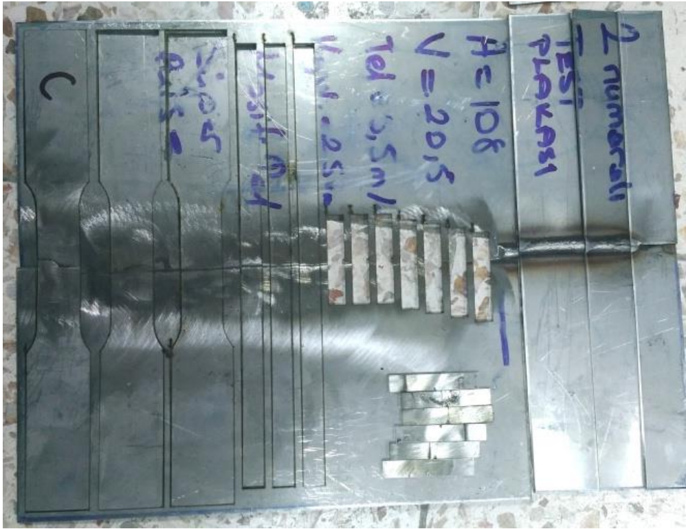
Resim 3.10. Kaynatılan test plakalarındaki numunelerin lazerle kesilmiş hali
