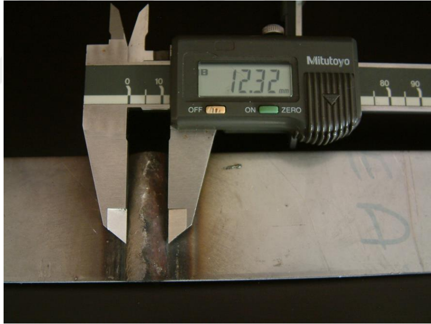
Resim 3.12. Kaynak kök ve kep genişliğinin ölçülmesi
