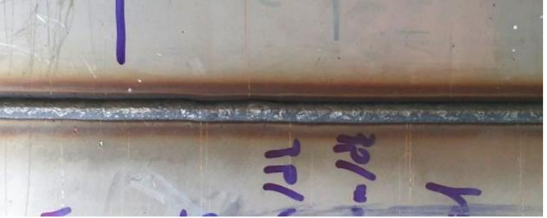
Resim E1.7. 2 numaralı kaynak kep bölgesi görünüm
