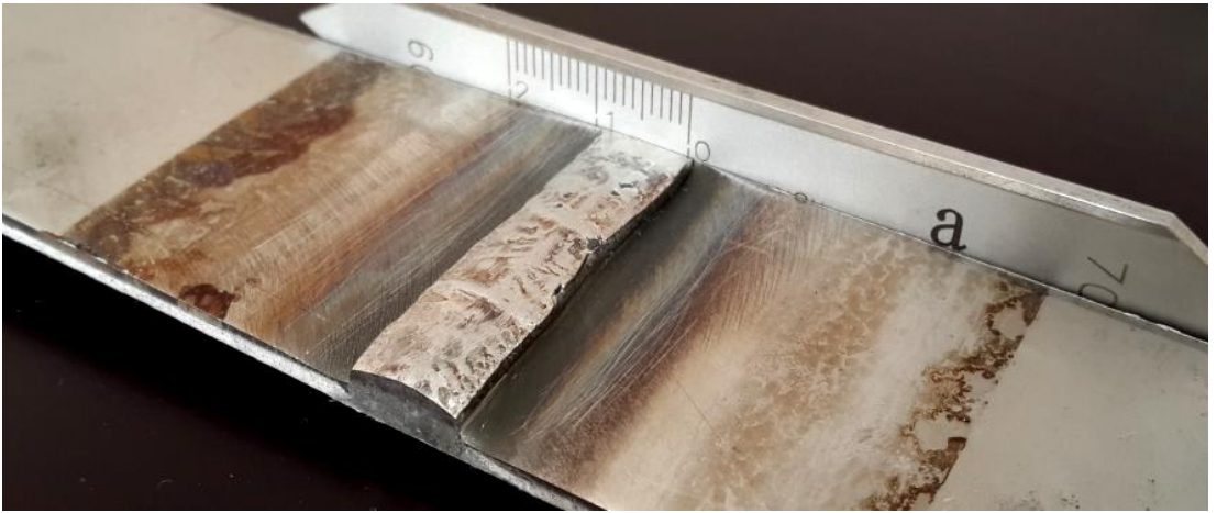
Resim E1.18. 7 numaralı kaynak kök bölgesi görünüm
