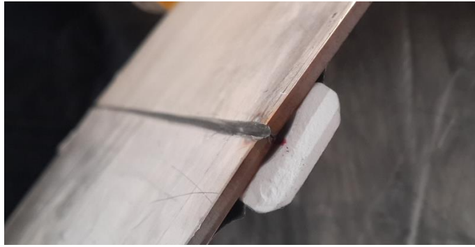
Resim 3.3. Seramik altlık kesit görünüm
