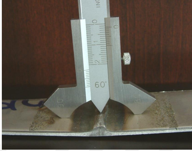
Resim 3.11. Kaynak kök ve kep yüksekliğinin kaynak mastarı ile ölçülmesi
