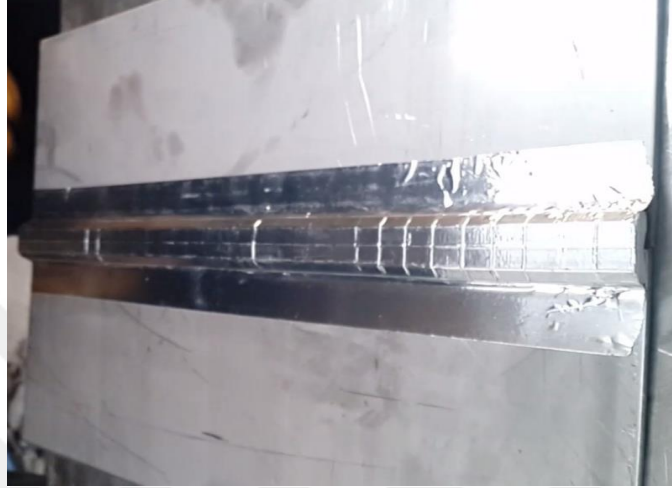
Resim 3.2. Seramik altlık yapıştırılması ve plaka arkası görünüm
