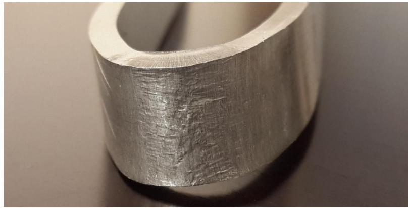
Resim E1.30. 6 numaralı kaynak kök kısmı eğme görüntüsü
