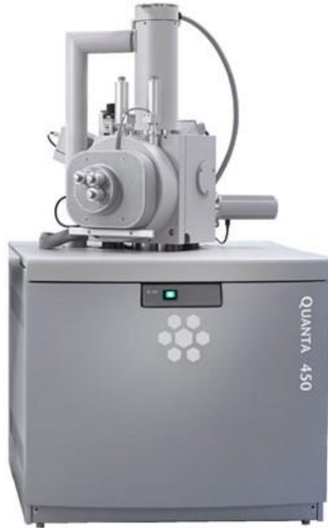
Resim 3.3. Hitit Üniversitesi Bilim ve Araştırma Merkezindeki FEI / Quanta 450 FEG marka modeline sahip SEM cihazı
