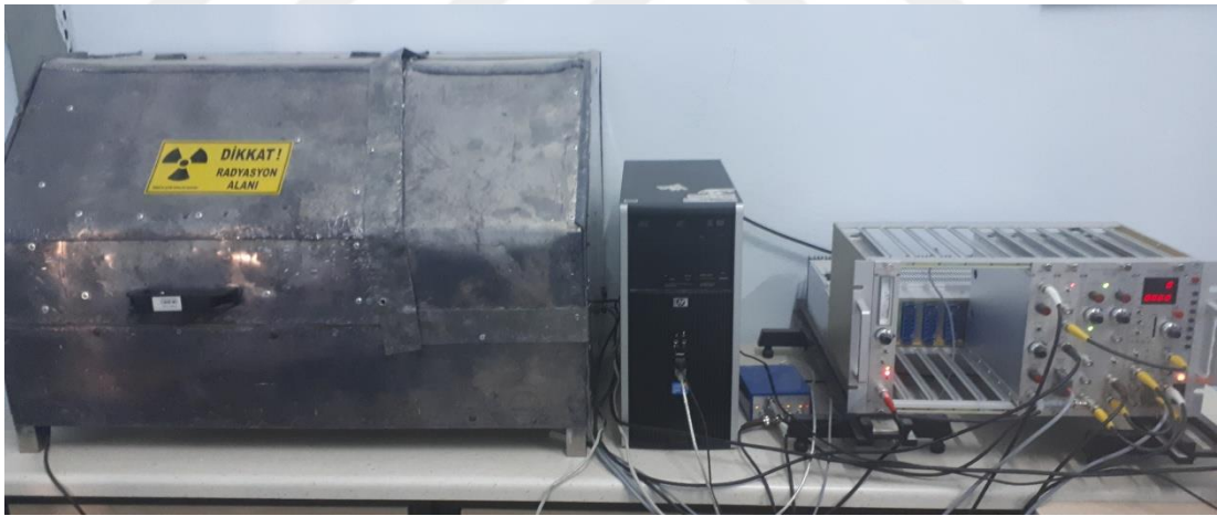
Resim 3.2. Hitit Üniversitesi Fen Edebiyat Fakültesi Fizik Bölümü Mössbauer Spektrometresi Cihazı
