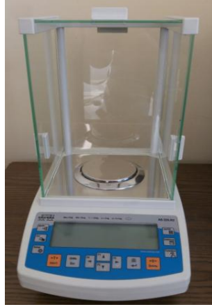
Resim 4.11. Dişlileri tartmada kullanılan hassas terazi
