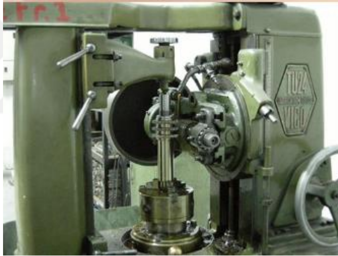
Resim 2.4. Azdırma tezgahında dişli çark imalatı
