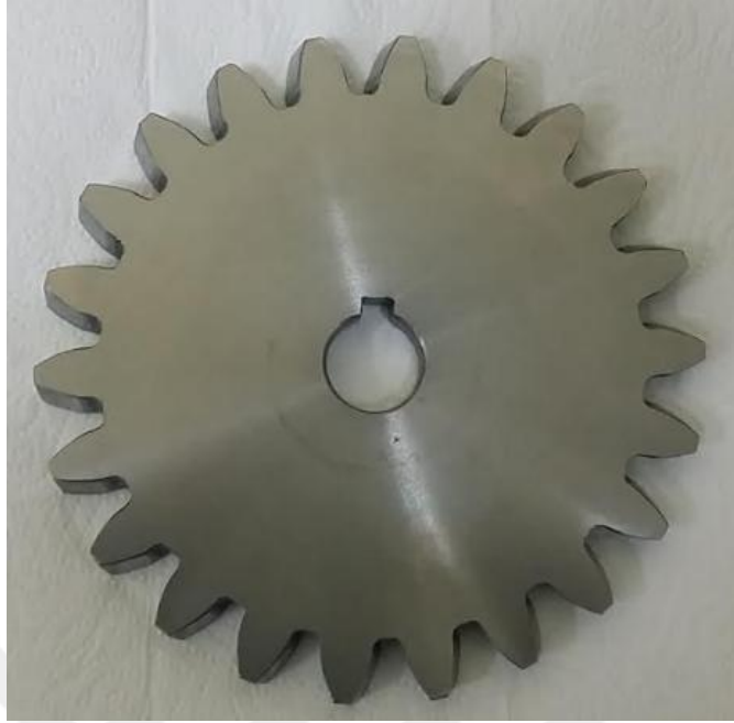
Resim 4.5. z = 22 , m_s = 6 , \beta = 15^\circ , sol helisel açılı dişli çark
