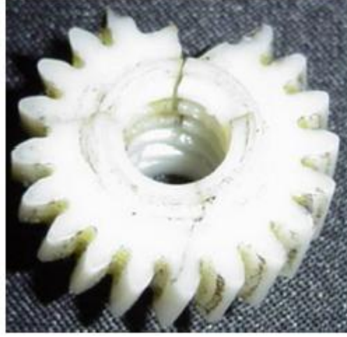
Resim 2.8. Kırılmaya maruz kalmış plastik dişli (Dindar, 2012)
