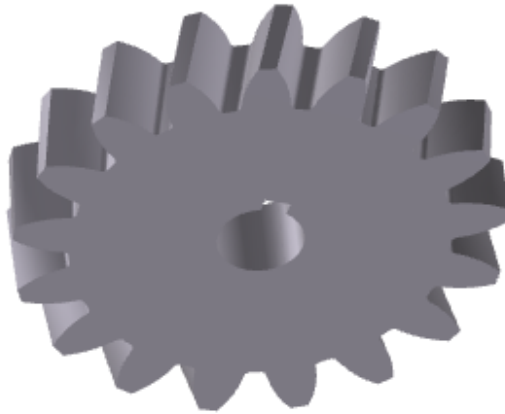
Resim 4.4. Solidworks programında modellenen z = 17 , m_s = 6 , \beta = 15^\circ , sağ helisel açılı pinyon dişli
