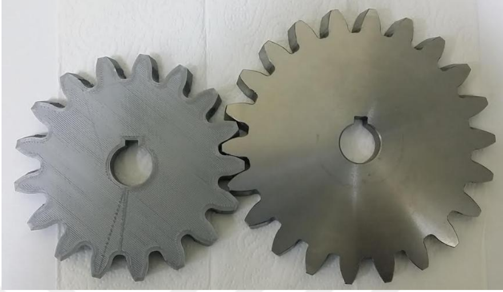
Resim 4.3. Dişlilere ait bitmiş ürün resimleri
