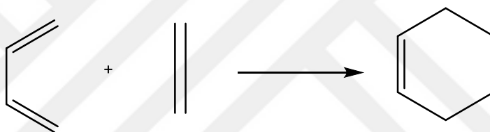
Şekil 2.1. Diels-Alder reaksiyonunun genel katılma reaksiyonu
