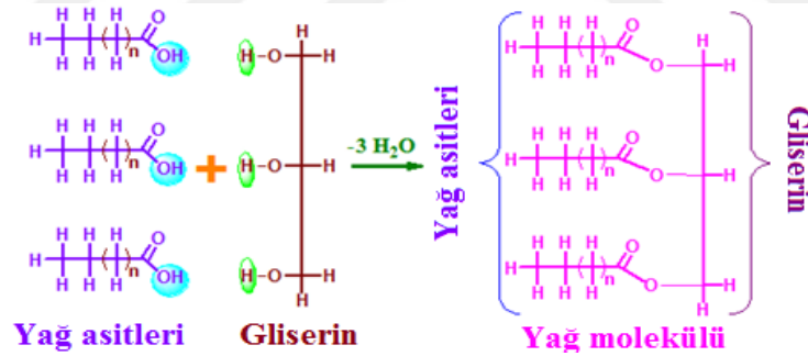
Şekil 2.2. Yağ oluşumu tepkimesi (Matharage ve ark., 2013)
