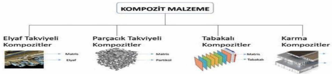
Resim 2.1. Kompozit malzemenin takviye ediciye göre sınıflandırılması (Vasiliev ve Morozov, 2001)
