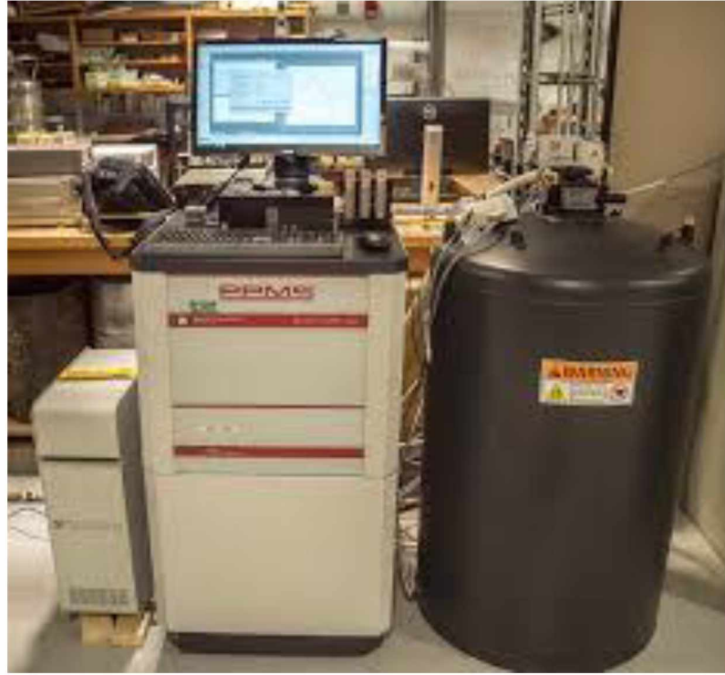
Şekil 3.4. Quantum Design PPMS-9t titreşimli örnek magnetometresi (sample magnetometre, VSM)
