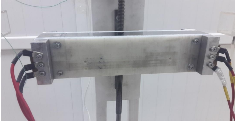
Resim 3.6. DC güç kaynağının bağlantı elemanları
