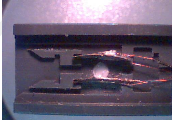
Şekil 2.5. İPMK'dan yapılmış çift diyaframlı bir pompa (Shahinpoor ve Kim, 2004)
