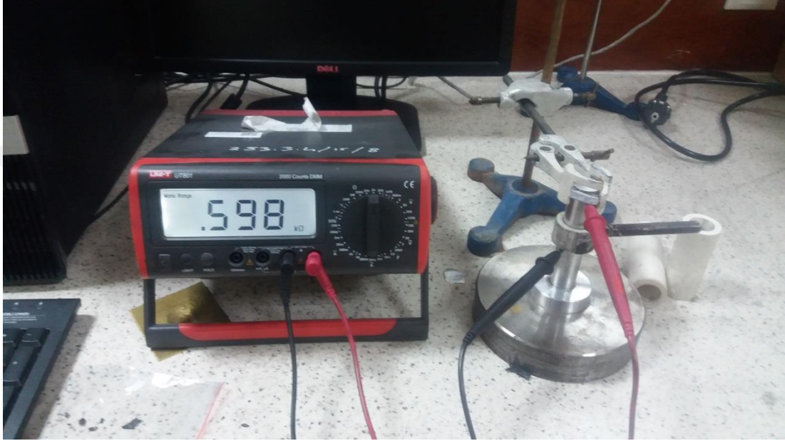
Resim 4.2. Pt-MA-ST/PEG kompozitin iletkenlik ölçümü
