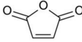
Şekil 2.15. Maleikanhidrit kimyasal yapısı
