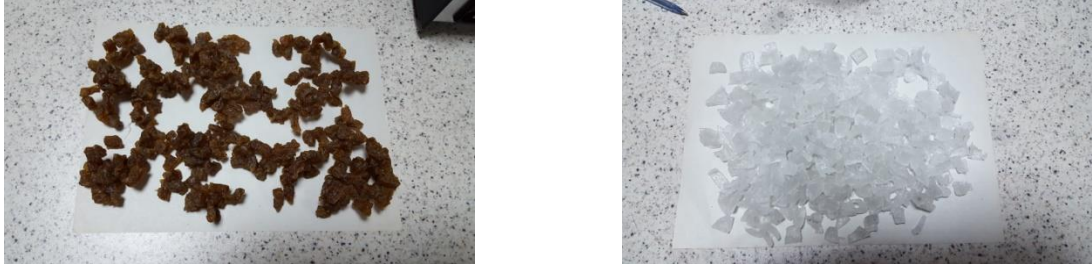
Resim 3.2. Karıştırılmaya uygun boyutlarda kesilmiş NR ve EPDM
