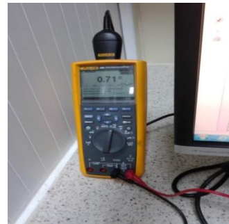
Resim 3.6. Multimetre ile direnç ölçümü
