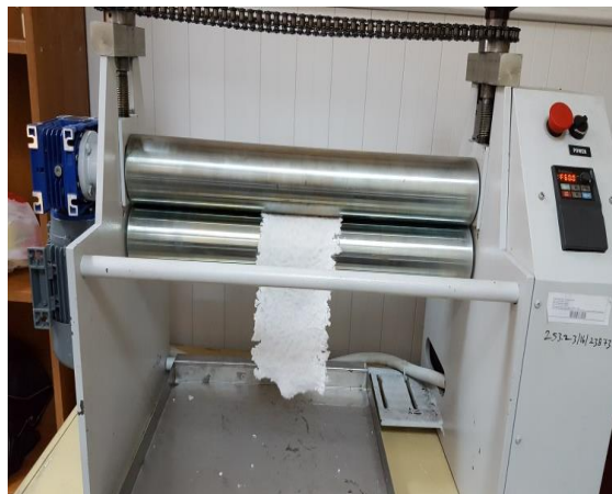
Resim 3.1. EPDM'in merdanede levha haline getirilmesi
