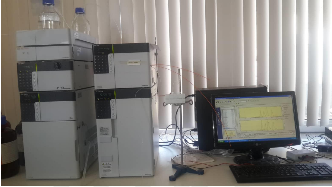
Resim 3.1. OTA analizinde kullanılan HPLC cihazı
