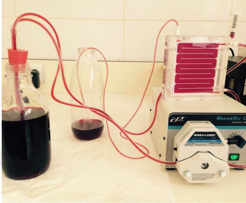
Şekil 3.2. Karadut berraklaştırması amacıyla kullanılan ultrafiltrasyon düzeneği
