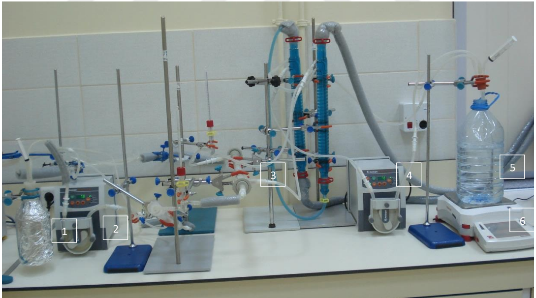
Şekil 3.4. Ozmotik destilasyon sistemi [(1) örnek, (2) pompa, (3) membran, (4) pompa, (5) konsantre tuz çözeltisi, (6) terazi]
