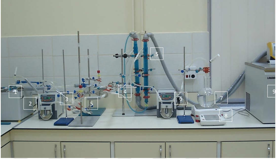
Şekil 3.3. Membran destilasyon sistemi [(1) örnek, (2) ısıtıcı sistem, (3) pompa, (4) membran, (5) ısı değişirici, (6) pompa, (7) saf su, (8) terazi, (9) soğutucu sistem]
