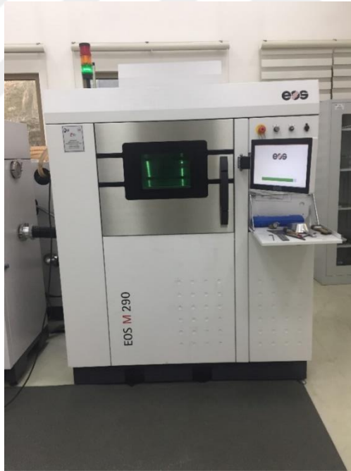
Resim 3.1. EOS M 290 doğrudan lazer metal sinterleme cihazı
