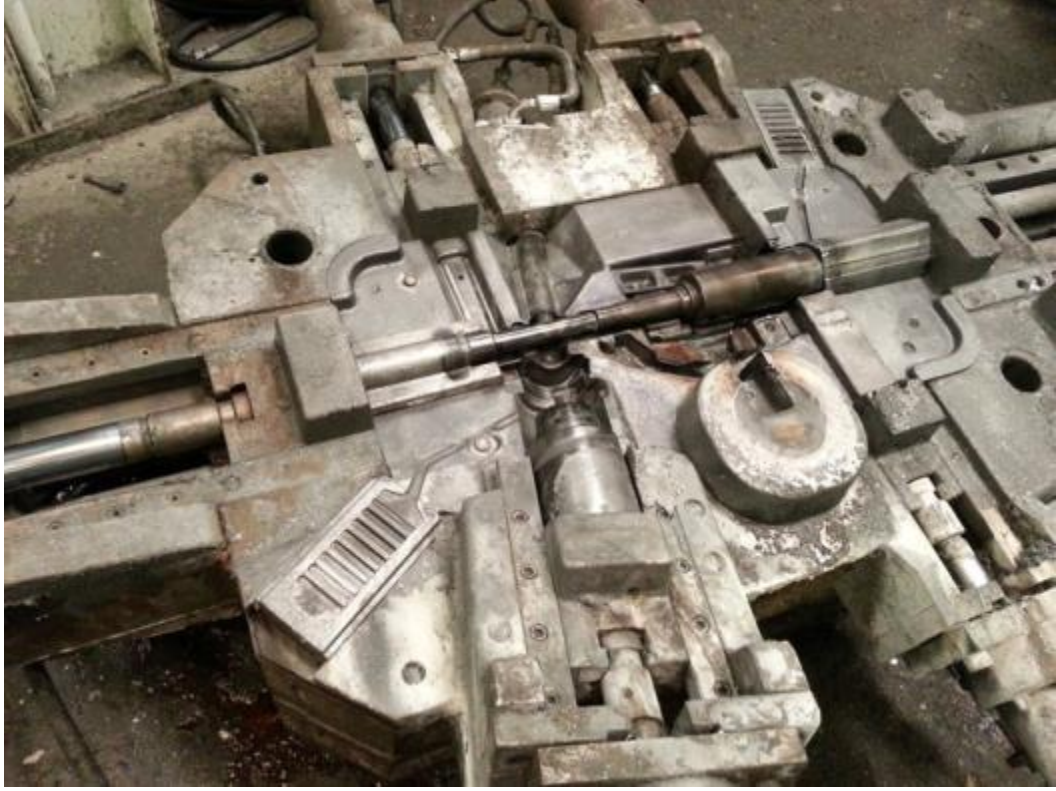
Şekil 1.3 : Hareketli kalıbın tezgahtan sökülmüş hali.
