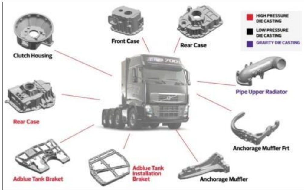
Şekil 2.2: Tesiste üretilen bazı iş makinesi parçaları ve üretim teknikleri.
