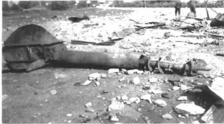
Şekil 5.2 : Patlama sonrasında karıştırıcı ve ön karıştırıcı 12 metre ötede bulunan parçaları (Berg, 1989).
