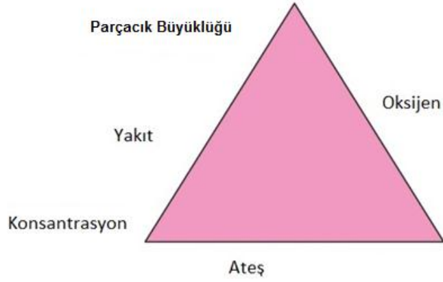
Şekil 3.1 : Tozlar için yanma tehlike üçgeni. (Abuswer, Dalhousie Univ.).
