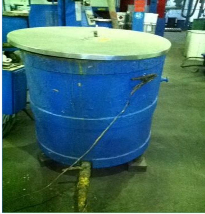
Şekil A.8.8 : Çözücünün taşınması sırasında elektronik panele bağlı taşıyıcı kazan örneği,
