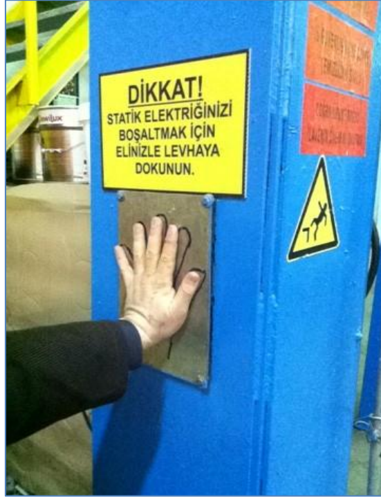
Şekil A.8.12 : Personel üzerinde birikebilecek statik yükün deşarj levhası
