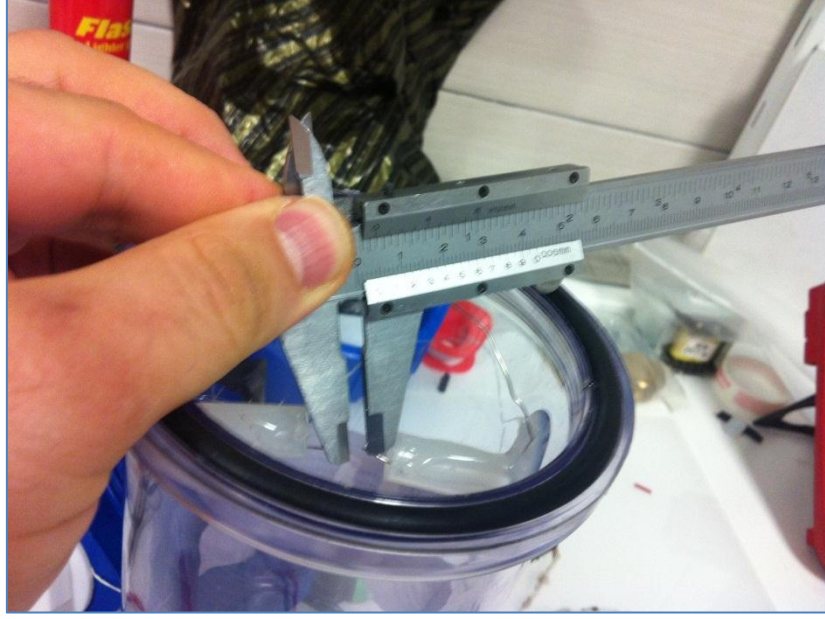
Şekil 6.5 : Elektrotlar arası optimum uzaklık tespiti.
