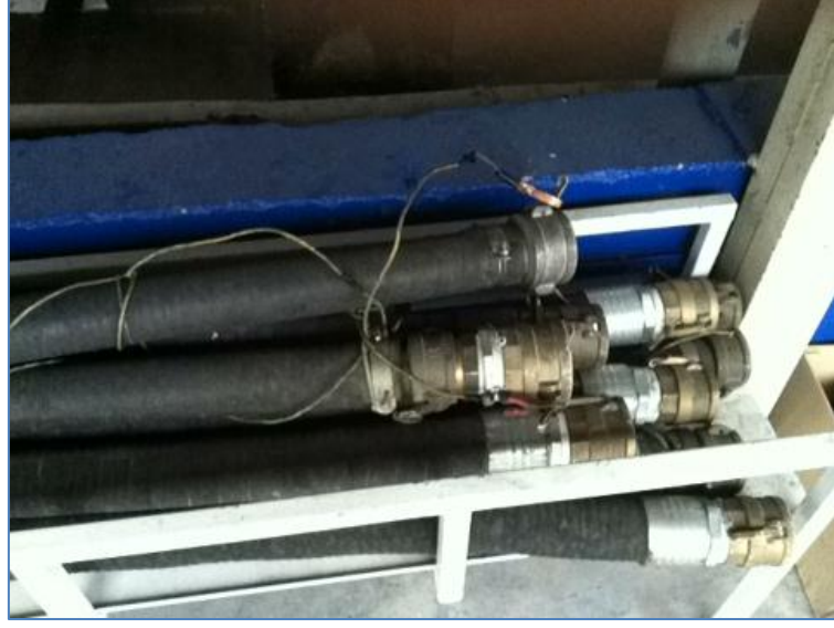
Şekil A.8.2 : Flaşlar arası iletken ile statik yük ntrleyici iletim borusu rneęi.
