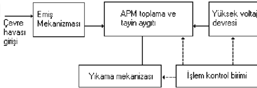
Piezoelektrik terazî yöntemi şeması
