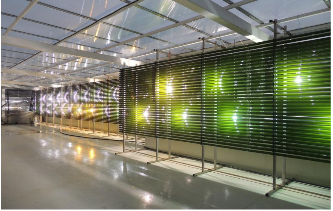
Şekil 3.2 Balık üretim tesisi canlı yem ünitesi
