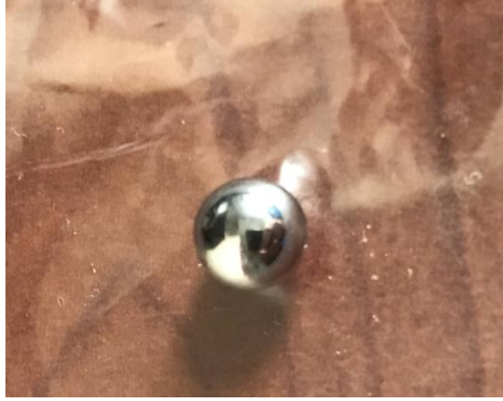
Şekil 2. 2: Bilyalı dövmede kullanılan paslanmaz çelik bilya
