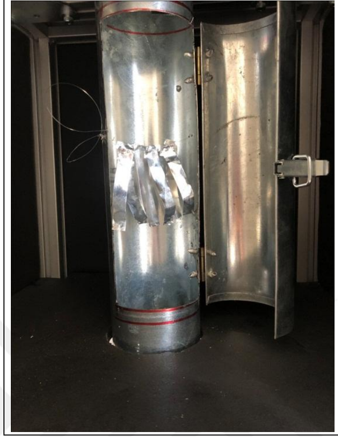
Şekil 3.5: LiNO 3 Emprenye Edilmiş Alüminyum Numunelerin Prototip Kabinine Yerleştirilmesi
