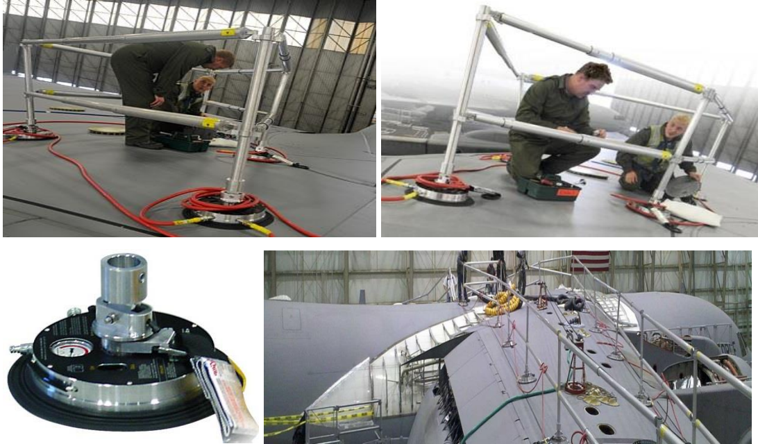
Resim 56: Wingripkorkuluk ve bariyer sistemi
