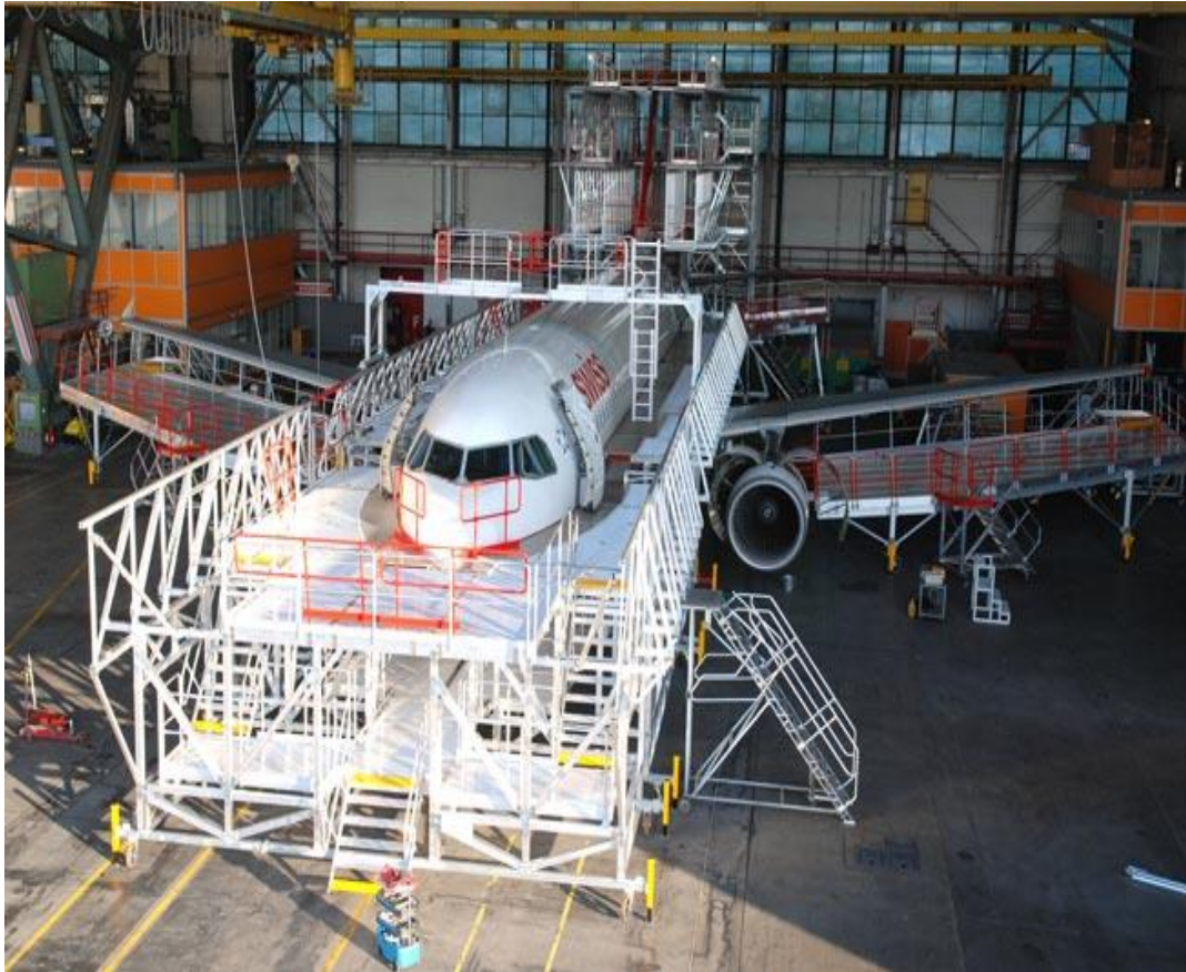
Resim 49: Dock sistemi içine alınmış bir uçak
