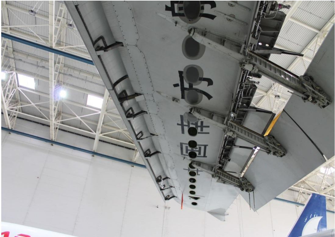
Resim 23: Yakıt tankı men hole kapakları
