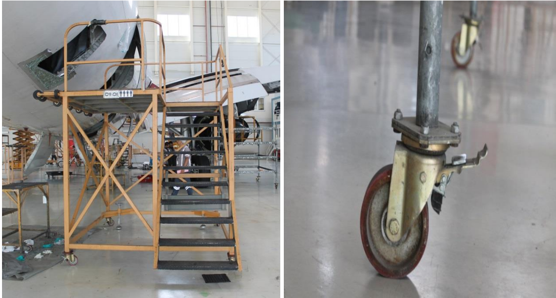
Resim 42: Arka kargo sehpası ve lastik – fren tertibatı
