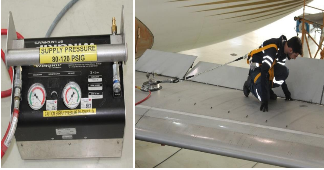
Resim 55: Çapalara giden havanın basıncını ayarlayan wingripregülatörü
