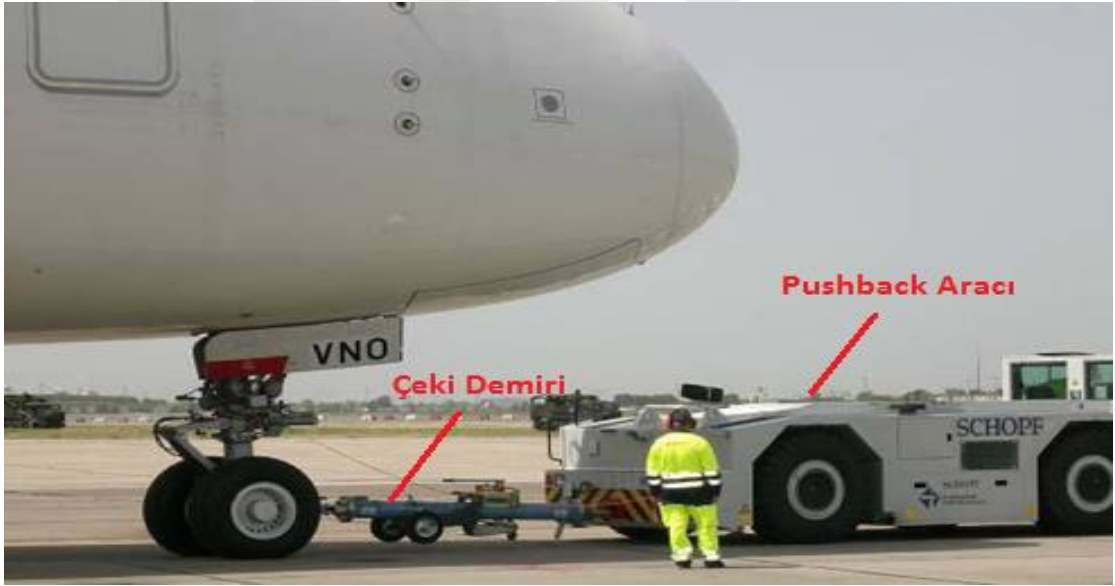
Resim 72: Uçak çekme işlemi
