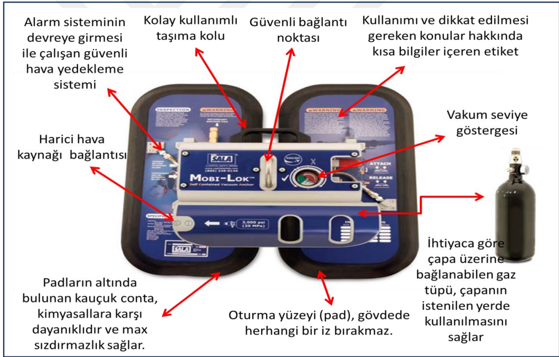
Resim: 59: Mobilok çapası ve özellikleri
