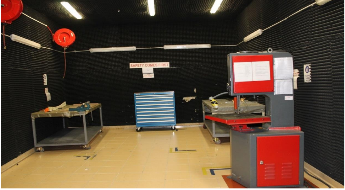
Resim 82: Yapısal atölyesinde bulunan izole edilmiş ses odası
