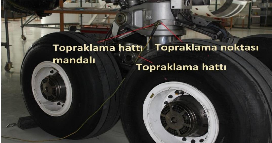
Resim 93: Topraklama hattına bağlanmış bir uçak
