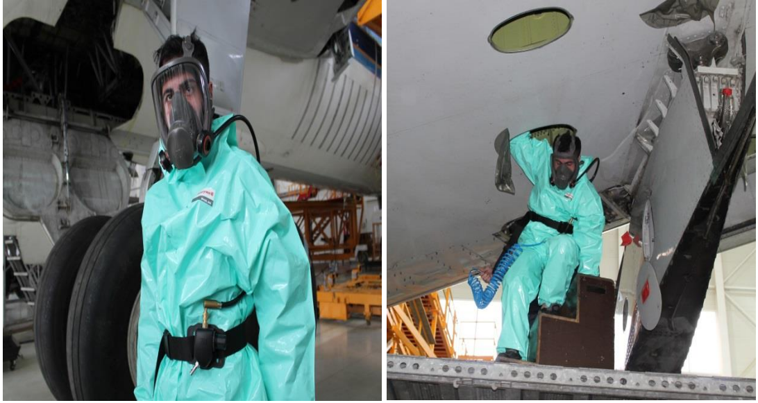
Resim 27: Yakıt tanklarında kullanılan solunabilir hava hattı sistemi
