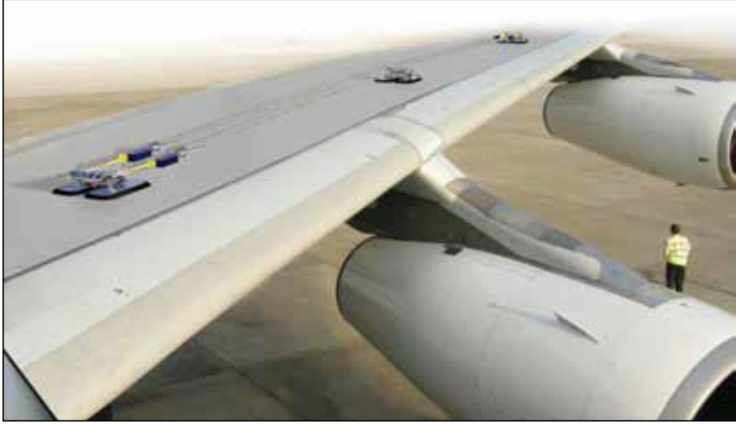
Resim 62: Kanat üzerinde oluşturulmuş mobilok ikiz yaşam hattı
