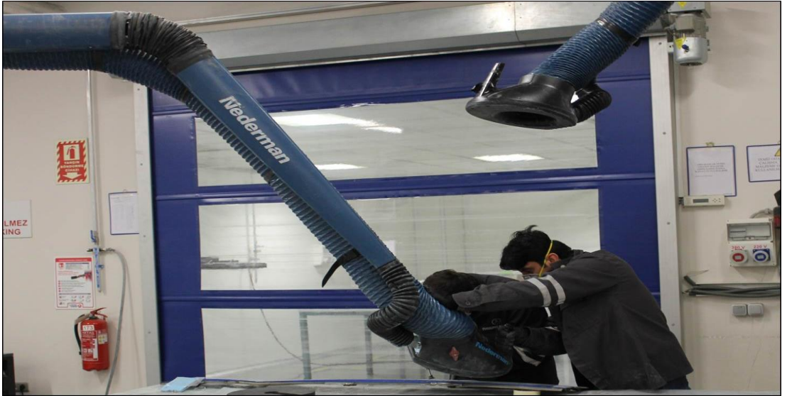
Resim 126: Zararlı tozları kaynağında yok eden ahtapot kollu toz emiş sistemi
