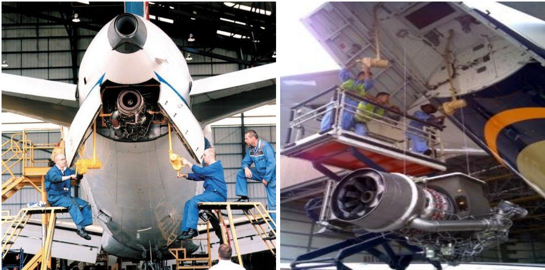
Resim 78: Caraskal ile APU söküm – takımı yapan teknisyenler
