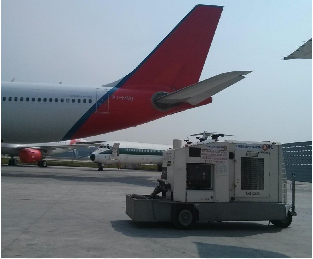
Resim 133: Uçağa elektrik vermek için kullanılan ground power unit
