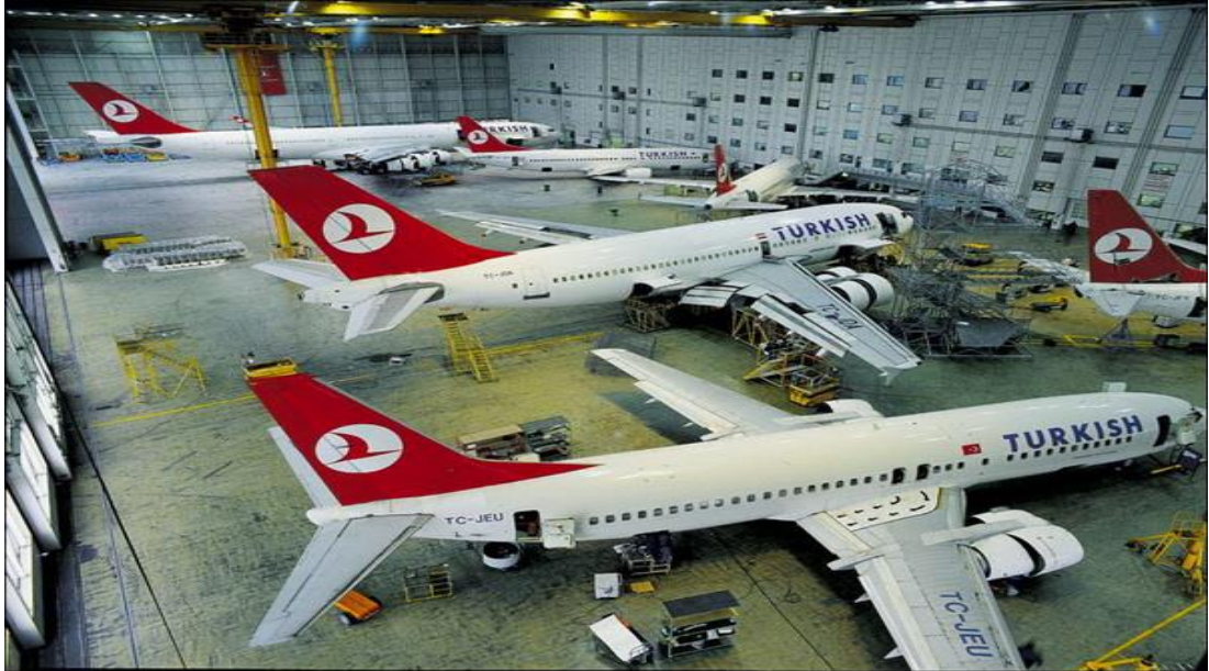
Resim 2: Base (ağır) bakımların yapıldığı hangar
