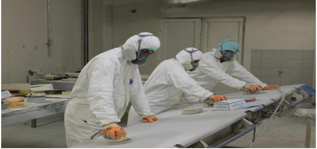
Resim 38: Elevatörü boya işleme hazırlayan teknisyenler
