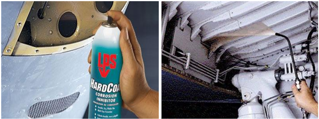
Resim 58: Uçaklarda kullanılan korozyon önleyici (LPS)'nin kullanımı
