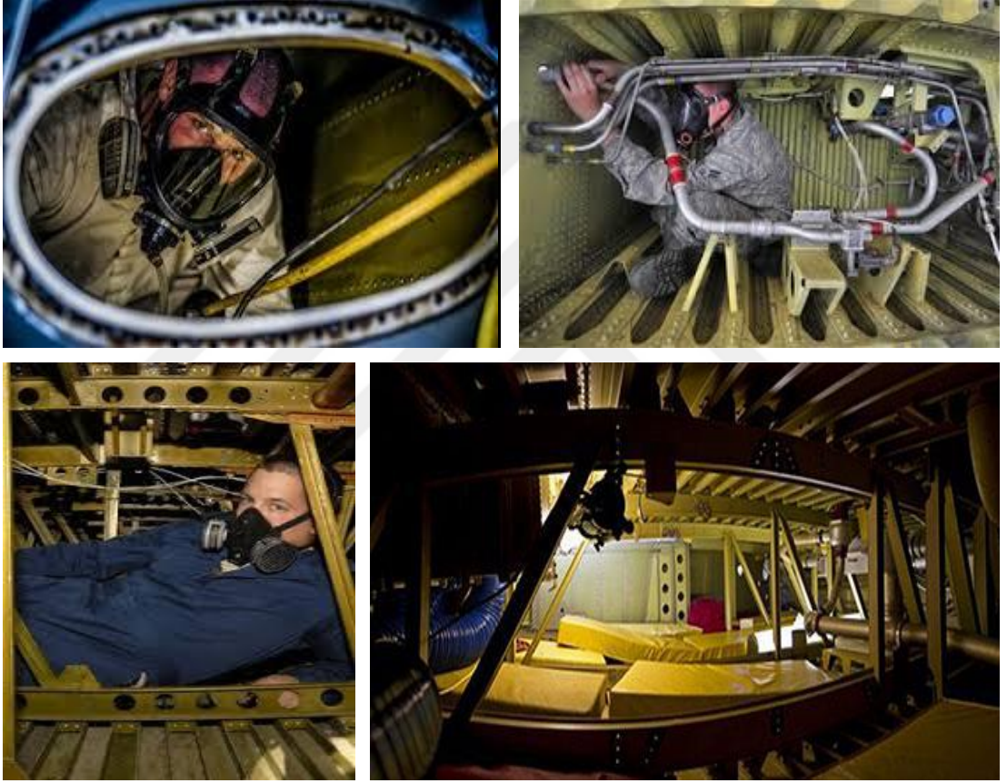
Resim 116: Uçak yakıt tankları oldukça dar ve sıkışık çalışma alanlarıdır
