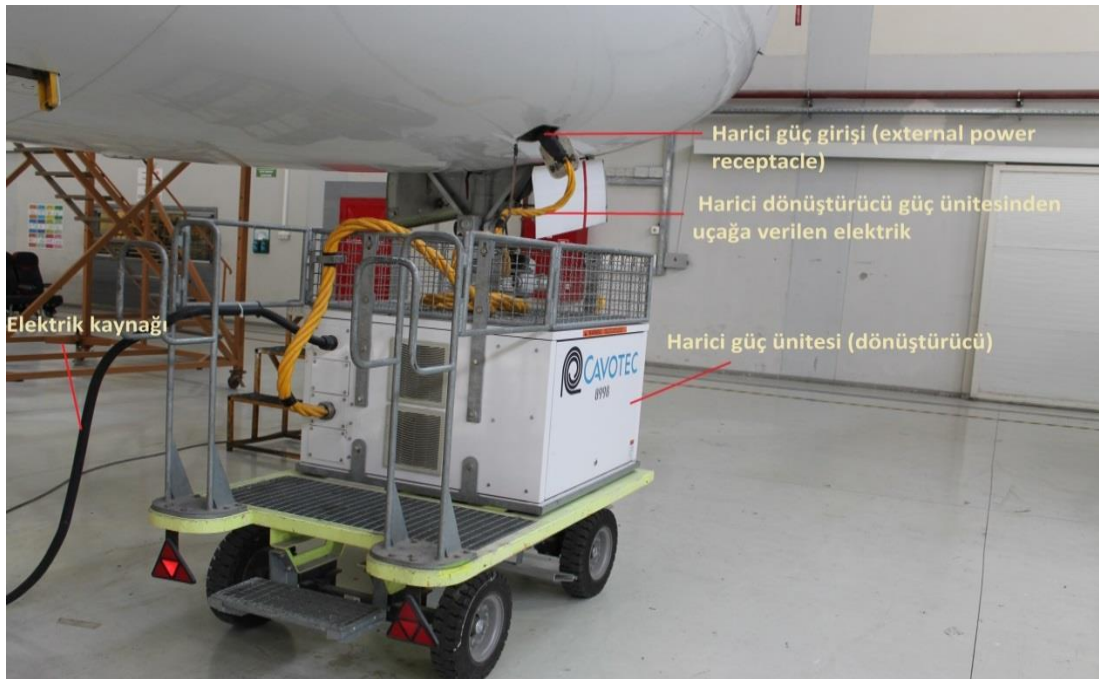
Resim 96: Hangar içinde kullanılan harici güç ünitesi (dönüştürücü)
