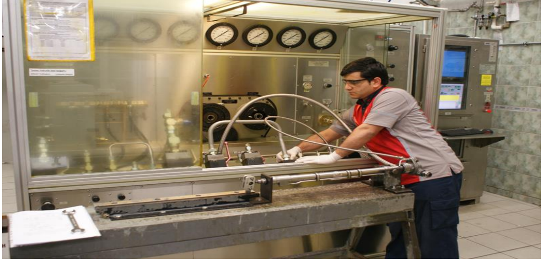
Resim 8: Hidrolik boruların basınç testi
