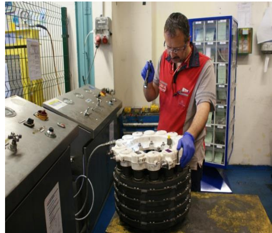
Resim 13: Brake unit (fren ünitesi) kontrolü
