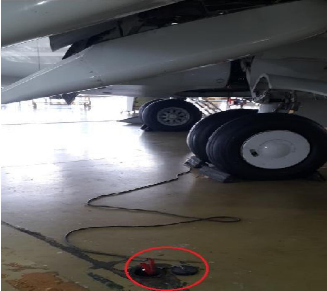
Resim 134: Uçağın topraklama hattına bağlanması (NAZLIOĞLU A. – 2014)
