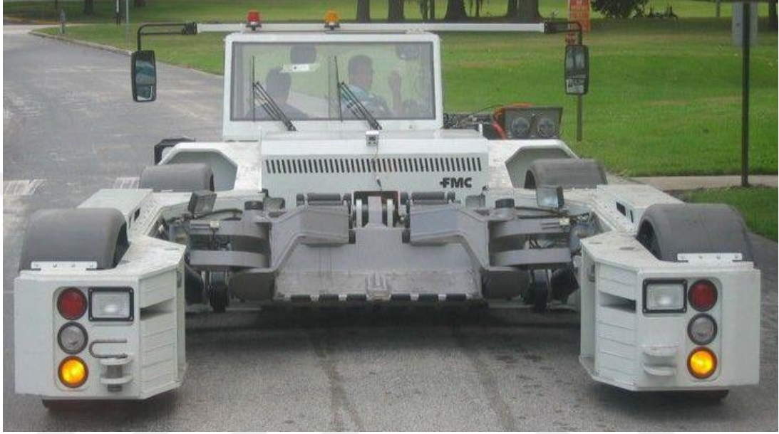
Resim 79: Hidrolik sistemli pushback aracı
