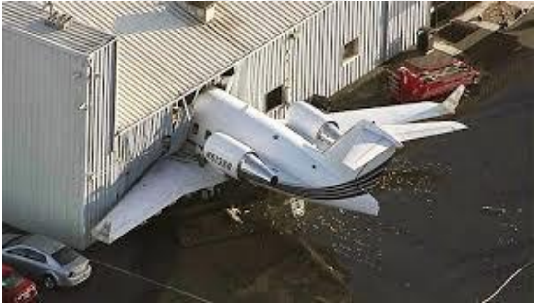
Resim 40: Motor testinde meydana gelen bir kaza
