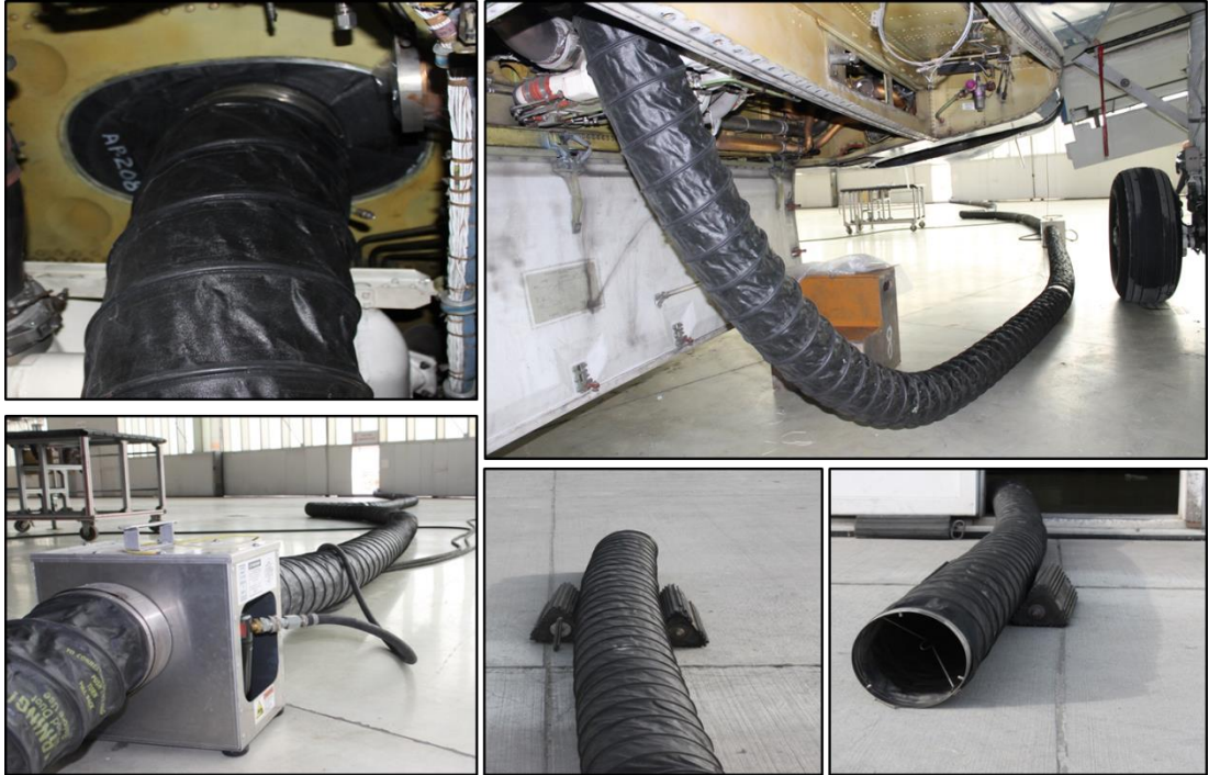
Resim 118: Yakıt tanklarının havalandırılmasında kullanılan tahliye hortumları
