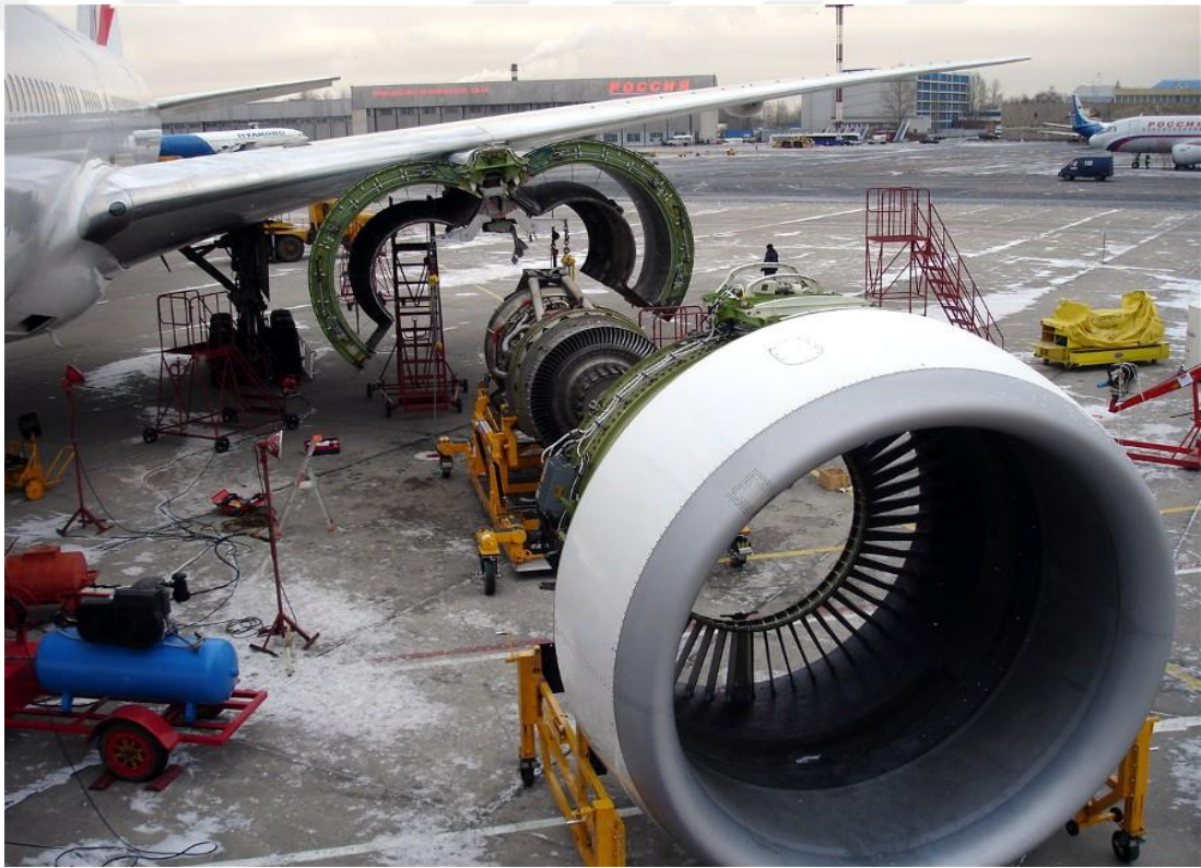
Resim 94: Boeing 777 tipi uçağın motor söküm – takım işlemi
