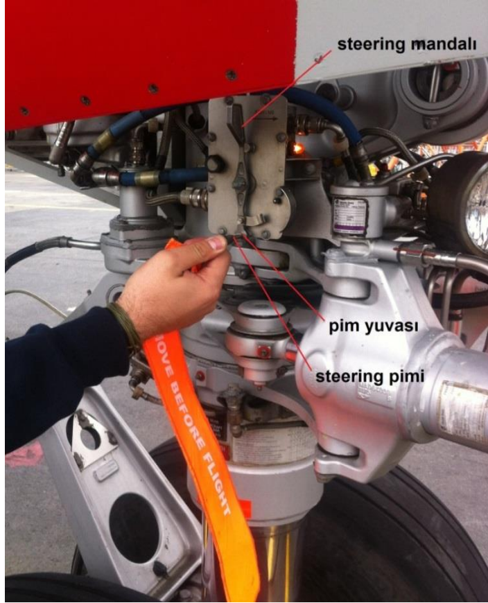
Resim 83: Steering mekanizması
