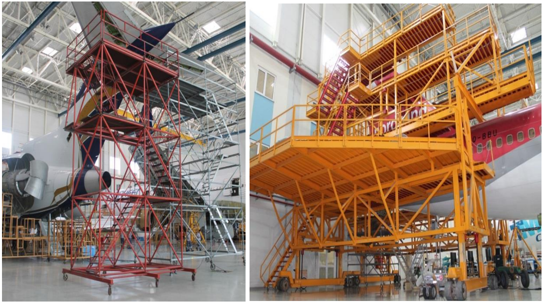
Resim 23: Uçak bakımlarında kullanılan ulaşım sehpaları
