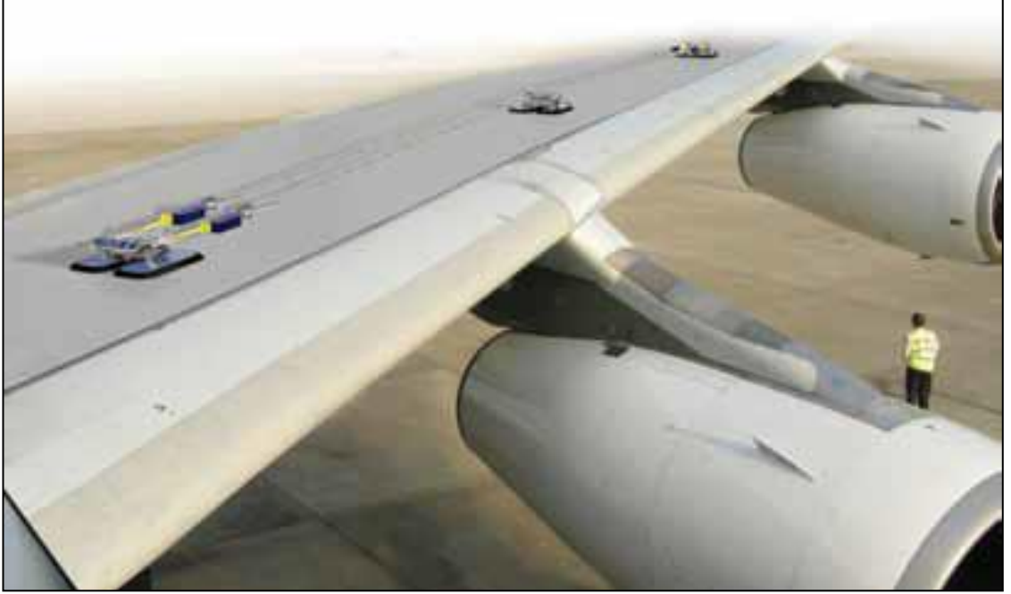
Resim 33: Kanat üzerinde oluşturulmuş mobilok ikiz yaşam hattı
