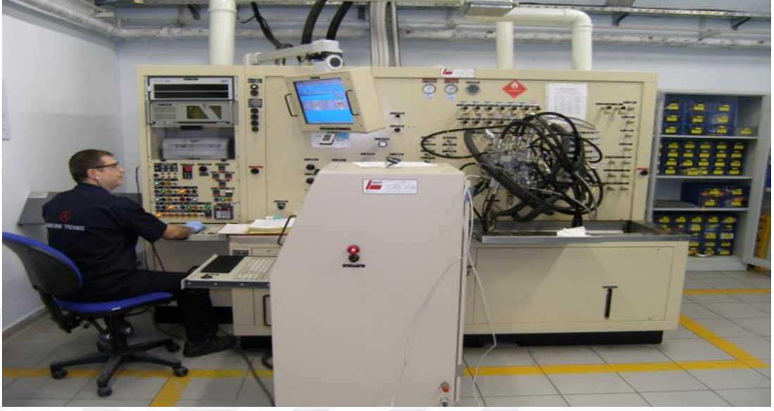
Resim 11: Yakıt boruları test ünitesi
