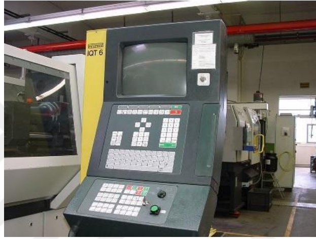
Resim 2.7. Enjeksiyon kontrol ünitesi (MEB, 2006)
