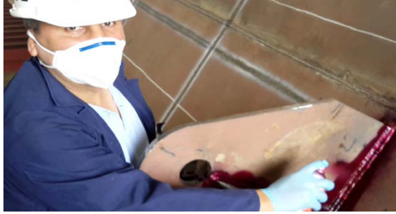
Resim 14. Yüzeye Penetrant Uygulanması
