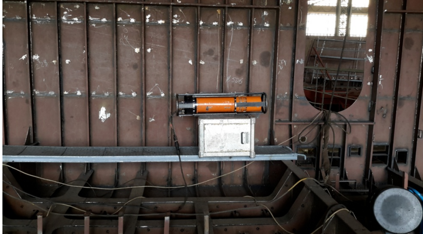
Resim 6. Gemi Bloklarının Kaynak Kısımlarının X-İşını Yöntemiyle Kontrolü
