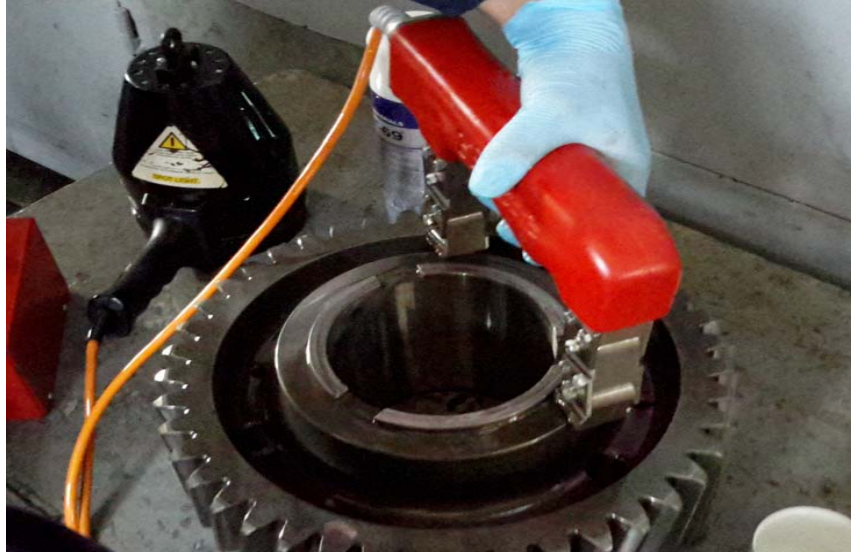
Resim 17. Yoke Cihazı İle Manyetik Alan Oluşturulması
