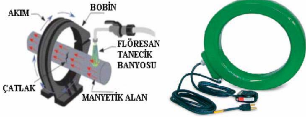
Şekil 8. Bobin ile Parçada Oluşturulan Manyetik Alan (Onursal, 2010)
