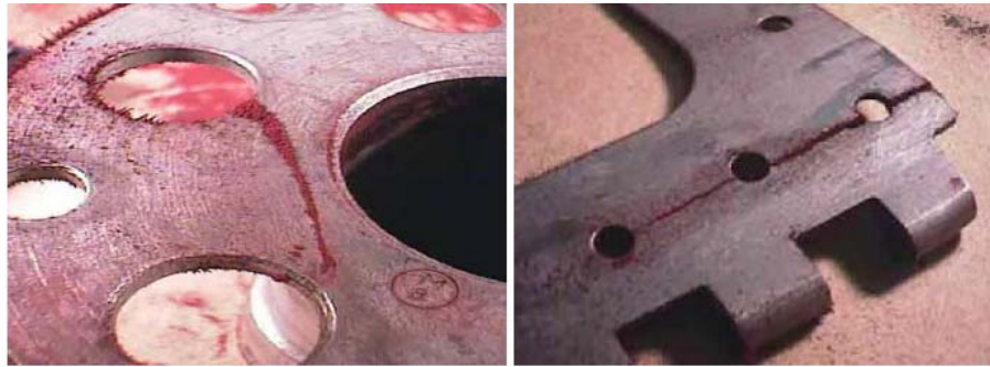
Resim 4. Demir Tozlarının Çatlaklar Üzerindeki Görünüşleri (Salma, 2011)
