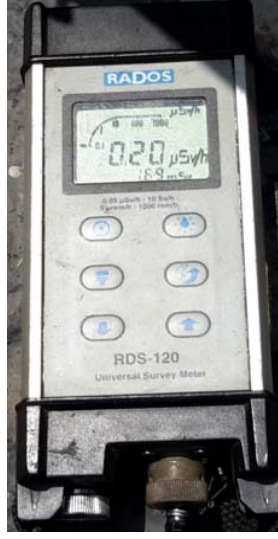
Resim 8. Ortamdaki Radyasyon Seviyesini Tespit Eden Radyakmetre
