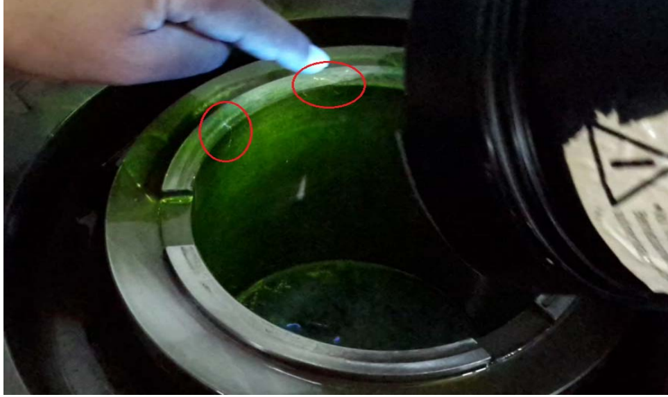
Resim 18. Ultraviyole Iřık Altında atlakların Grnm
