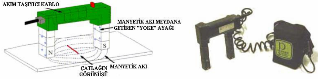
Şekil 7. Yoke Cihazı ile Manyetik Parçacık Kontrolü (Doğru, 2014)
